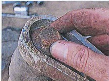
**03.104** L'opération suivante consiste à démonter l'axe et ses roulements. Démontez d'abord le chapeau à écrou de 22 mm...
