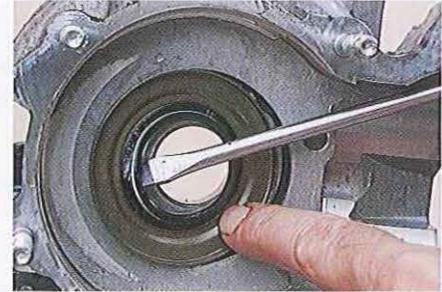
01.94 Le joint d'huile côté embrayage peut alors être retiré. Soulevez-le avec précaution et jetez-le. Les joints doivent toujours être remplacés en cas de démontage des carter.
