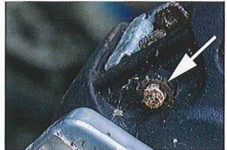
03.225 La goupille est bloquée par un petit clip – utilisez une pince pour le sortir. Remplacez-le s'il est corrodé.
