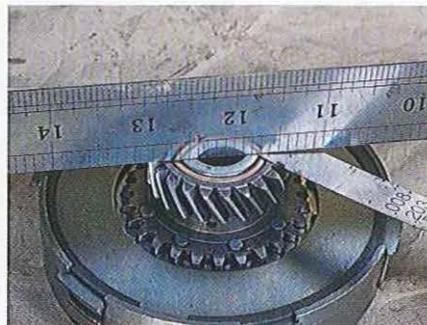
01.234 Un écart de 2 mm au minimum doit exister entre le moyeu de l'embrayage et la face du pignon mené pour éviter un arrachement.
