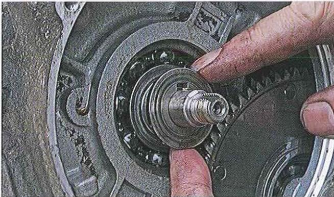
01.65 Une rondelle faisant cale d'épaisseur se trouve derrière l'embrayage, soit lisse comme celle-ci...
