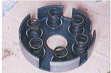
01.212 Retirez le plateau de pression pour accéder aux ressorts et aux cuvettes. La longueur des ressorts sera contrôlée et les cuvettes examinées pour relever des signes d'usure et d'éventuels dommages.
