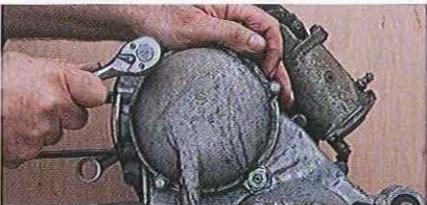
01.53 Les couvercles d'embrayage sont très semblables ; ils sont retenus par trois vis de fixation de 10 mm sur les moteurs anciens et de 8 mm sur les plus récents. Décollez le couvercle en le frappant légèrement ou en manœuvrant doucement le levier d'avant en arrière.
