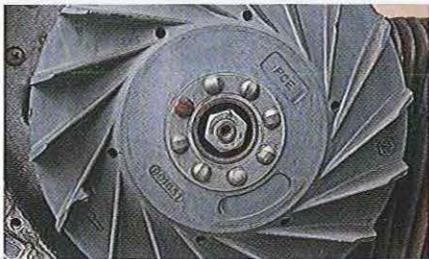
01.40 Le cache central de l'écrou doit être extrait s'il n'est pas manquant (cas fréquent). Après immobilisation du rotor, l'écrou peut être dévissé avec une clé à tube de 19 mm.
