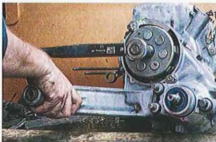
01.237 Glissez l'embrayage sur le vilebrequin et remontez la rondelle et l'écrou. Serrez au couple.
