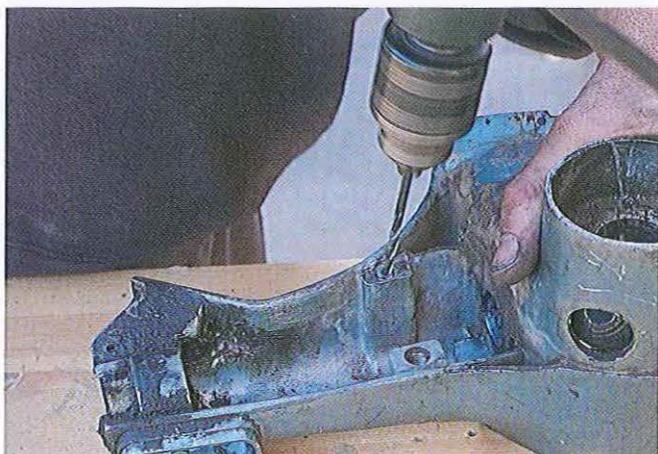
03.15 Les vis retenant les plaquettes sont souvent cassées dans la partie inférieure du capotage. Pour les extraire, percer d'abord le centre du moignon.
