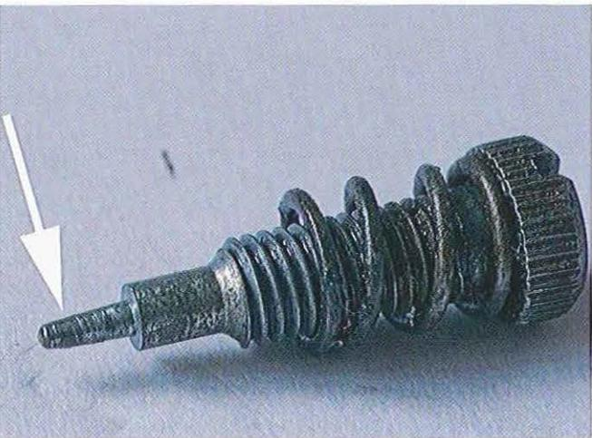
02.42 Aspect de la vis de réglage de richesse. Examinez l'extrémité conique (flèche) qui doit être exempte de bourrelet ou de rayure.
