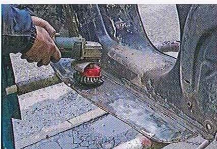
04.7 Si vous préférez utiliser des abrasifs, une brosse métallique tressée montée sur une meuleuse d'angle éliminera la peinture et la rouille. Mais portez au moins des lunettes de protection pour éviter les projections de morceaux de fil métallique.
