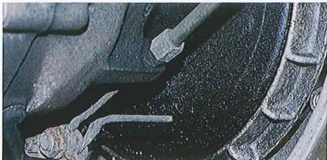
01.9 Sous le bloc moteur, détachez l'écrou de retenue du câble de frein et le raccord vissé qui retient le câble d'embrayage, et écartez-les du moteur en les séparant des douilles de réglage venues de fonderie avec le bras oscillant. Le câble de frein peut être difficile à retirer du fait de son diamètre et des déformations dues au serrage. Si ces câbles doivent être changés, ne pas hésiter à les couper.
