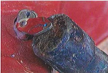
04.88 Faites sauter le cache avec un marteau. En principe le rivet de retenue saute en même temps sinon il faut le percer.
