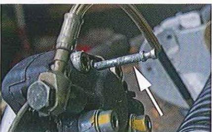
03.226 La goupille est alors extraite du côté du clip. Elle est souvent corrodée et bloquée. Dans ce cas, mettez du dégrippant et tournez-la jusqu'à ce qu'elle sorte.
