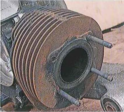
01.29 Après dépose de la culasse, séparez le cylindre du carter. Les cylindres en fonte (sauf sur T5) sont normalement rouillés. On peut les sabler extérieurement et les repeindre avec une peinture résistant à la chaleur. Dans tous les cas, la rouille doit être éliminée.
