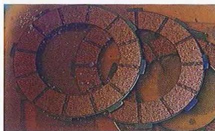
01.219 Faites tremper les disques liège une nuit dans de l'huile de boîte. Après mise en place des disques lisses et garnis, remontez le jonc de retenue ; vérifiez que les extrémités sont bien en place dans la cloche.
