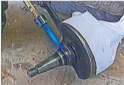
01.135 Chauffez la bague avec une lampe à gaz pour la dilater.
