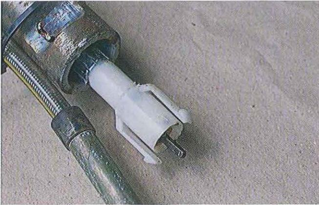
03.41 Sur les modèles EFL, le câble du compteur est retenu par un système à pinces comme ici. Pressez les pinces pour le dégager. Sur les modèles antérieurs au type EFL, le câble du compteur est tenu par une bague moletée qui se dévisse. Le contact d'allumage sur les premiers modèles est plus facile à démonter en retirant la bague de retenue à l'extérieur du capotage et en laissant l'ensemble pendre avec tout le faisceau électrique.
