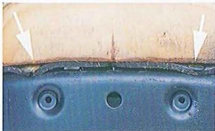
07.38 S'il y a deux rivets en plastique à l'arrière, faites-les sauter avec un tournevis.
