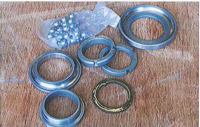
03.255 La composition des roulements de colonne de direction, identique sur tous les modèles de la gamme Vespa, a permis de limiter les coûts. Ce modèle possède des billes libres utilisées au tout début du moteur à distributeur rotatif et sur les Motovespa jusqu'au milieu des années 1960.
