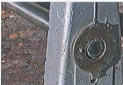
**03.130** N'oubliez pas de remonter la rondelle nettoyée et bloquée en place par sa languette avant d'assembler le flasque et de remonter l'axe.
