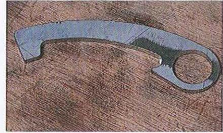
01.58 La griffe spéciale de blocage d'embrayage est utile, mais on peut aussi immobiliser la bielle ou le vilebrequin pour desserrer l'écrou de retenue de l'embrayage.
