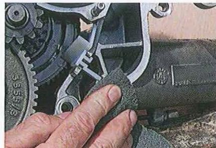
**01.123** Examinez l'état des plans de joint et leur parfaite planéité et éliminez toute trace de joint ou de produit d'étanchéité.
