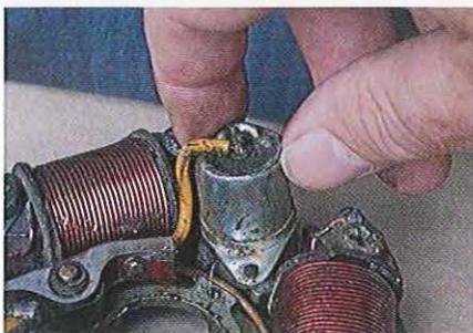
**06.25** Le condensateur est tenu par une seule vis (ou simplement poussé en place sur les modèles P) et son fil est soudé au sommet. À remplacer aussi à chaque remise en état.
