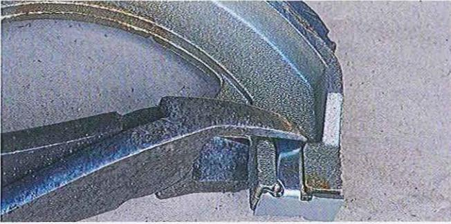
03.142 Les plaquettes d'appui des cames doivent être immobilisées. Il suffit de replier les languettes pour les tenir sur les segments.
