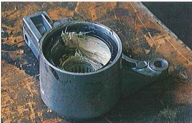
03.183 Les roulements à aiguilles du porte-moyeu à disque sont identiques et sortent de la même façon.
