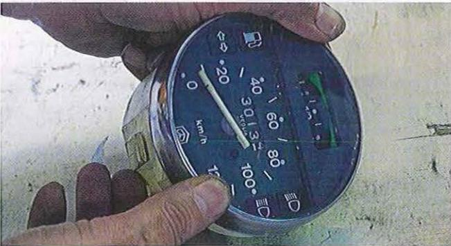
07.47 Le verre et le cerclage neuf sont mis en place et fixés par repliement du bord arrière de la collerette autour du corps du compteur – un travail délicat.
