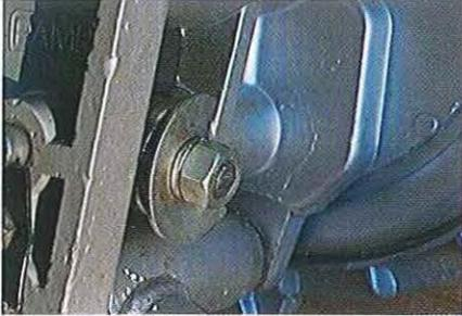
03.148 La fixation inférieure du ressort doit être serrée à fond avant l'installation du ressort.
