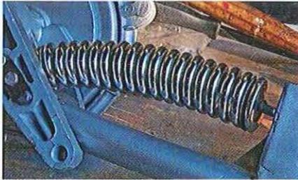
03.152 Le bas du ressort étant fixé sur l'ancrage inférieur, prendre le haut avec une lame de tournevis ou similaire pour l'accrocher sous la platine de la colonne. Une fois dans cette position, amenez en tapant légèrement la partie filetée à passer dans l'ouverture de la platine. C'est évidemment plus difficile avec un ressort plus ferme.
