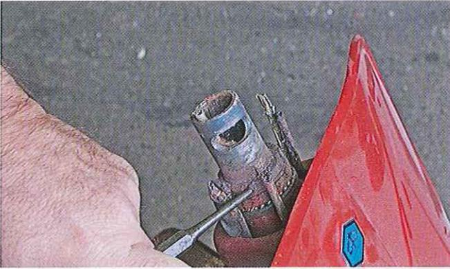
**03.244** La bague supérieure sera certainement très serrée. Il existe des clés à ergots (Piaggio) spéciales (voir plus loin), mais lorsque la bague est dans cet état, imbinez de dégrippant et avec une chasse, débloquez la bague qui, dans tous les cas, devra être changée.
