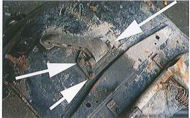
04.81 L'ensemble du pédalier est fixé au plancher par des boulons. Ceux-ci étant démontés, l'ensemble peut être déposé de la coque après avoir détaché le câble côté roue.
