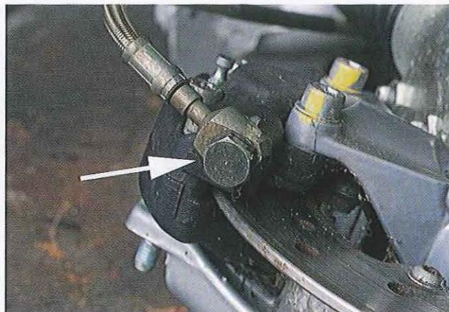
03.228 Si la canalisation hydraulique est encore connectée, pompez pour chasser les pistons. Les flèches indiquent les plaquettes.
