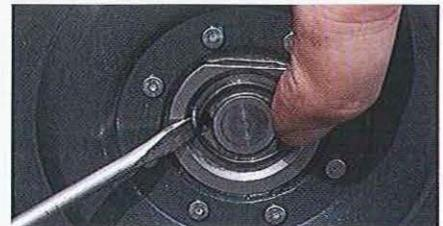
01.55 Sur tous les types, l'épingle de retenue prise sur deux trous de la pastille de butée est extraite avec un tournevis plat, passé sous le fil du côté du gros trou ; appuyez en faisant levier pour libérer le couvercle.
