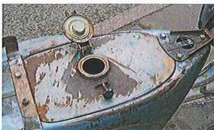
**02.1** Le réservoir est retenu par des boulons à l'arrière et par la charnière de la selle à l'avant. Ici, un type ancien pour coque large – les fixations sont très accessibles et identiques sur tous les modèles et pour toutes les années.
