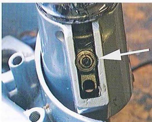
03.46 Le côté embrayage comporte un contacteur supplémentaire (flèche) ajouté sur les modèles à démarrage électrique. Il empêche le démarrage si le levier n'est pas tiré. Ne le démontez pas sauf s'il est défectueux : débranchez simplement les fils sur le boîtier de connexion derrière le bossage de l'avertisseur et retirez l'ensemble.
