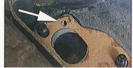
01.258 Le carburateur repose sur un autre joint d'étanchéité. Malheureusement, celui-ci a été mal découpé. Le trou (flèche), pas assez grand et mal centré, bloque en partie le passage de l'huile, avec les conséquences qu'on peut imaginer pour le moteur.
