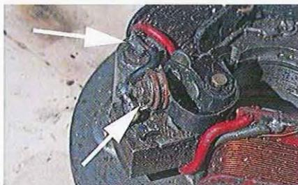
**06.26** Les contacts de la série P paraissent différents mais fonctionnent sur le même principe que les versions antérieures avec une cosse vissée pour le fil (flèche du bas) et une connexion soudée sur le condensateur (flèche du haut).
