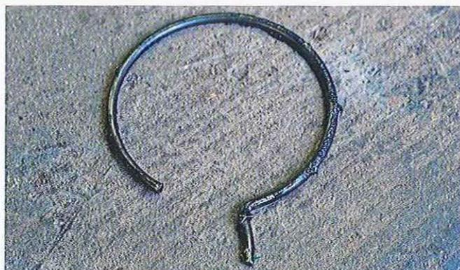
01.78 Retirez le jonc élastique puis desserrez la bague fileté à gauche. Elle se desserre donc en tournant vers la droite. Il existe un outil spécial, mais on peut normalement utiliser avec précaution un jet de bronze et un marteau pour desserrer la bague.
