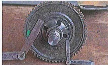
01.166 Avant de démonter le train de pignons, vérifiez le jeu longitudinal avec des cales d'épaisseur.
