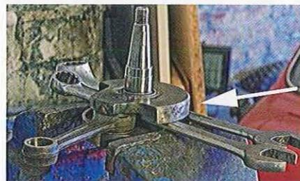
01.142 Ou bien immobilisez le vilebrequin dans un étau en calant la masse sur deux clés ou deux morceaux d'acier. Les coups de marteau n'étant absorbés que par une des masses, aucune rotation n'est possible. Cette méthode d'immobilisation est préconisée par Piaggio.
