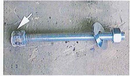
01.148 Un outil de repose de vilebrequin existe, mais il est facile d'en fabriquer un. Prenez un long boulon, une rondelle et un écrou de la dimension de l'extrémité du vilebrequin. Soudez un écrou d'embrayage (flèche) sur la tête du boulon et c'est prêt.
