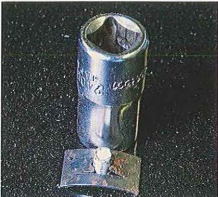
07.6 Les écussons latéraux sont souvent retenus par des clips élastiques. S'ils sont très serrés, utilisez une douille pour les pousser en place.
