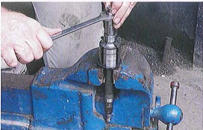
01.172 Serrez l'arbre dans un étau muni de mordaches douces puis, avec une clé à fourche, démontez la tige de sélection (axe du croisillon). Le pas étant à gauche, tournez dans le sens normal du serrage.
