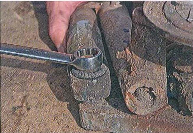
**03.97** Démontez les boulons en haut et en bas de l'amortisseur et déposez ce dernier. Vérifiez son fonctionnement et l'absence de fuite d'huile. Les rechanges sont bon marché.
