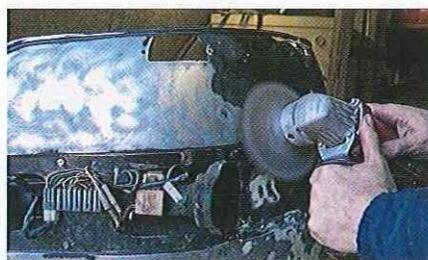
04.9 Une ponceuse équipée d'un disque de grain 40 est tout aussi efficace, mais elle ne peut atteindre les recoins de tôle ni les angles des bords roulés.
