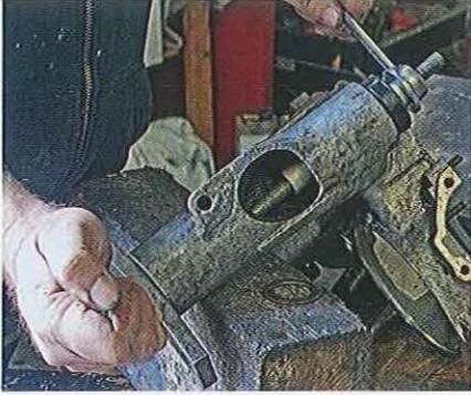
01.289 Confectionnez un outil de pose avec de la tige filetée, des écrous et des rondelles adéquates. Lubrifiez le caoutchouc avant montage.
