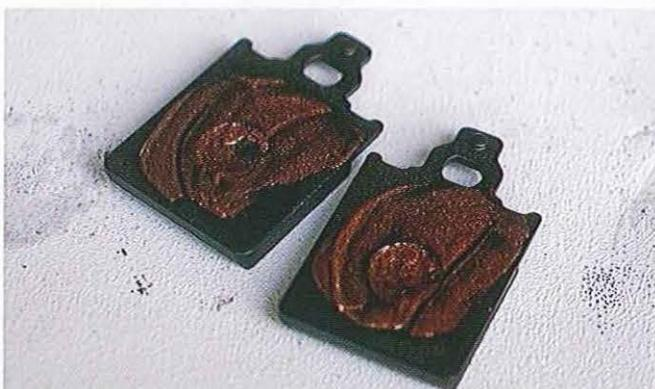
03.241 Graissez aussi le dos des plaquettes avec cette même graisse.
