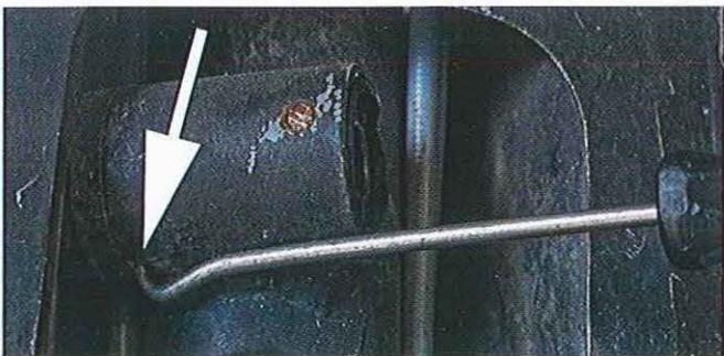
04.96 Il existe un trou (flèche) sur le dessous du tube de serrure. En insérant un crochet ou un tournevis fin, on peut repousser un ergot et extraire le barillet du tube.
