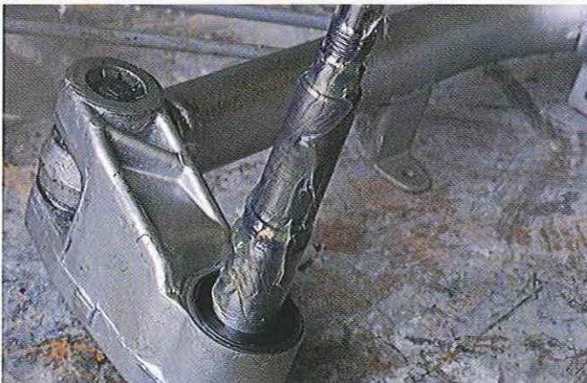
03.209 Le grand joint torique et la cale de butée en acier sont mis en place et la fusée peut être graissée.
