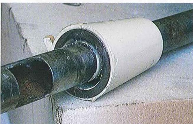
03.20 Graissez les tubes et la grande rondelle côté sélecteur.
