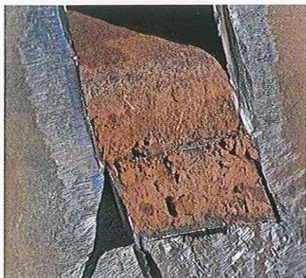
04.38 Faites attention là où la coupe passe au niveau du tunnel central. Attendez-vous à trouver davantage de corrosion entre les épaisseurs de tôle.
