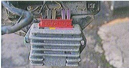
**06.41** Les modèles équipés d'une batterie ont un boîtier à cinq bornes faisant fonction de redresseur et de régulateur de tension.
