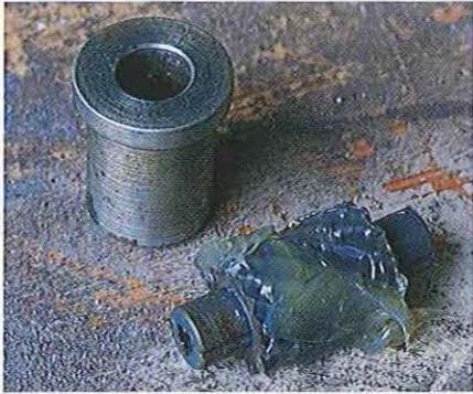
03.219 Graissez l'entraînement de compteur et insérez la douille bien nettoyée.
