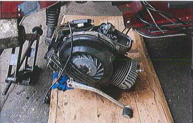
01.17 Le débattement de l'amortisseur arrière permet de faire pivoter le moteur suffisamment pour l'écartier de la coque. Le boulon de fixation peut être retiré. Supportez l'arrière du moteur et séparez-le de l'amortisseur et de son support. Le bloc moteur peut alors être porté sur l'établi pour le dégroupage.
