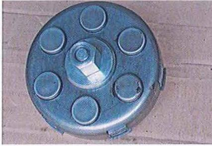
01.205 La cloche est logée dans le renforcement à l'avant de l'embrayage.
