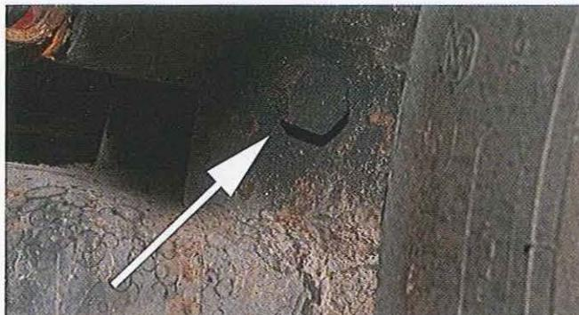
01.10 Le silencieux peut alors être démonté. Il est tout à fait possible de sortir le moteur avec l'échappement, mais celui-ci est souvent serré sur la pipe de sortie du cylindre et il est plus facile de le détacher alors que le moteur est toujours fixé dans la coque. On trouve un boulon de fixation (tête de 17 mm) devant la roue et passant à travers le bras oscillant souvent grippé. Imbibez-le de fluide dégrissant et faites-le tourner pour le dégager. Il faut démonter la roue pour l'extraire.
