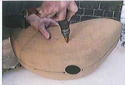
03.158 Un découpoir a été utilisé ici par l'extérieur après perçage d'un trou pilote correspondant au repère tracé à l'intérieur.
