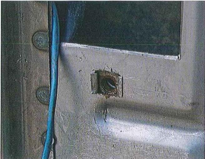
04.82 En cas d'utilisation d'un plancher neuf, on trouve un perçage pour recevoir le boulon de la pédale. Il doit être limé en forme de carré pour permettre de rabattre les languettes d'immobilisation de l'écrou prisonnier contre la tôle du plancher.
