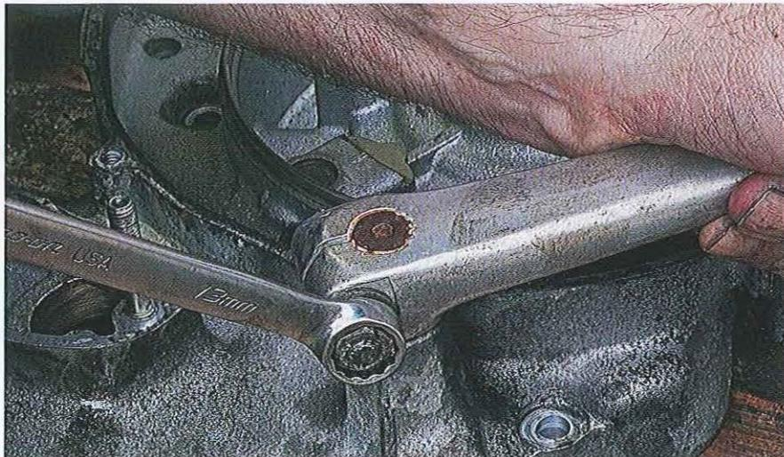
01.100 Le dernier mécanisme à extraire du carter moteur est le kick starter. Démontez d'abord le levier (la pédale) en desserrant l'écrou, puis en le faisant glisser sur les cannelures de l'axe.
