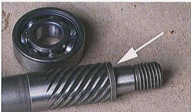
**03.133** Remontez ensuite l'axe fusée. N'oubliez pas de remettre sur l'axe la petite cale (flèche). Serrée, elle demande à être chassée bien droit, avec précaution et avec une douille longue du diamètre approprié.
