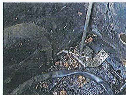
**04.69** Les capots des scooters PX EFL sont verrouillés par l'intérieur de la coque. Sous la selle, deux leviers coiffent le système fixé dans la coque par des vis autotaraudeuses. Une fois ces vis retirées, l'ensemble peut être sorti de la coque, mais l'opération demande un peu d'attention.
