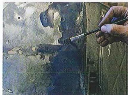
04.56 Appliquez immédiatement un bon produit antirouille sur les cordons de soudure meulés, là où les conditions d'une reprise de la corrosion sont idéales.
