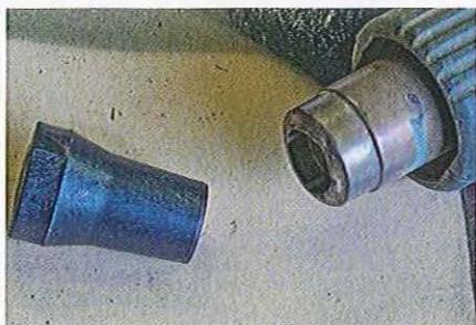
07.51 Les patins des types PX sont en plastique plus dur. Un réchauffage à l'air chaud facilitera la pose.
