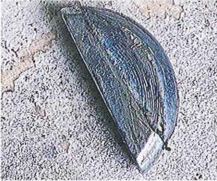
01.51 bis L'état de la clavette demi-lune sera contrôlé : pas d'usure, ni de déformation des flancs. Les clavettes neuves ne coûtent pas cher.
