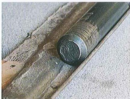
**04.66** La forme finale sera obtenue en martelant la tôle sur un rond d'acier ou une mèche du diamètre approprié pour arriver à la courbure d'origine.
