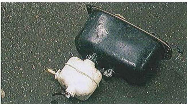
02.7 Si votre scooter est à graissage automatique, le réservoir d'huile se trouve juste sous le réservoir d'essence. Le type PX, qui est en plastique, peut être démonté. Les versions antérieures, beaucoup plus rares, sont en métal et fixées définitivement au réservoir d'essence.
