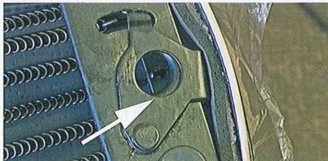
07.42 Les selles de rechange peuvent être livrées avec un mécanisme de verrouillage grippé ou mal usiné. Vérifiez que le pêne à ressort coulisse bien sur toute sa longueur. Il sera peut-être nécessaire de limer l'ouverture pour que la platine vienne bien se fermer sur la gâche de la carcasse.
