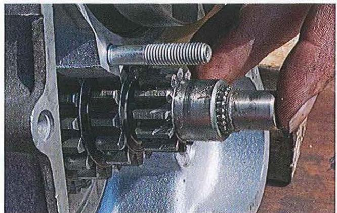
01.164 Remontez les aiguilles en les collant à la graisse sur l'arbre. Insérez l'arbre juste pour retenir les aiguilles : il restera assez de jeu pour remettre l'ensemble en place et l'arbre dans l'alésage du carter.
