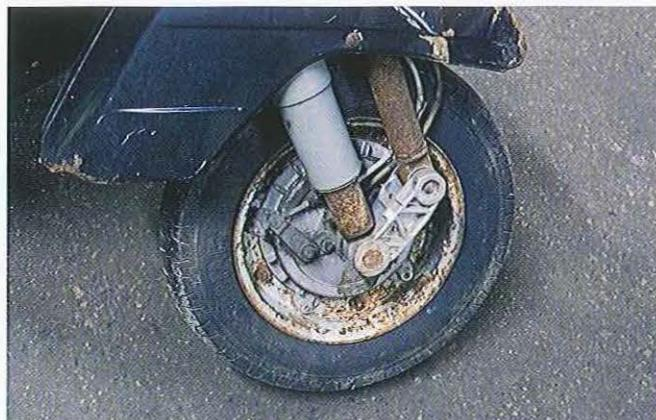
03.165 Une suspension et un moyeu avant de PX bien fatigués. Rouillé et dépourvu de protection sur le bras oscillant, l'ensemble du moyeu avant n'est plus amorti et le pivot a du jeu.
