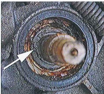
03.175 Le moyeu une fois sorti, on voit au fond du logement un circlip souvent recouvert de graisse. Nettoyez d'abord.
