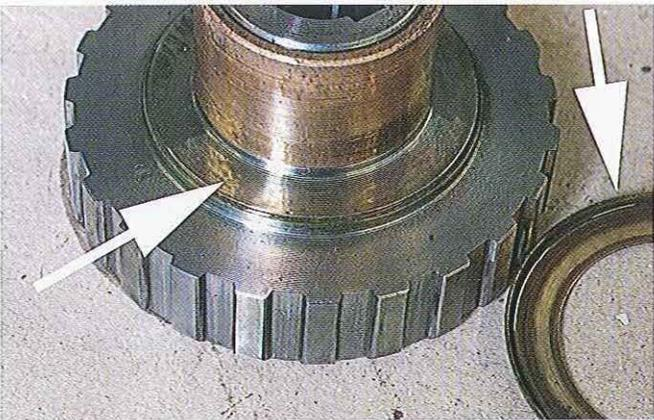
01.230 On trouve une rondelle de butée et une douille (flèche) comme sur l'embrayage précédent, mais la rondelle est plus large. Il faut néanmoins la remplacer dans tous les cas. Notez son orientation avant de la déposer.
