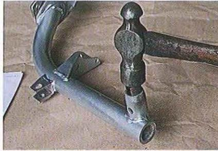
03.122 Insérez l'entretoise centrale (si elle a été démontée auparavant) en alignant le trou avec celui du graisseur.
