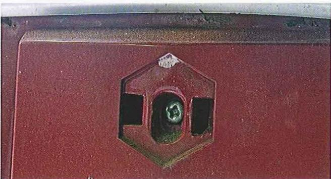
07.55 La vis de retenue du haut est cachée sous l'écusson Piaggio. Deux autres vis se trouvent dans le coffre de tablier.
