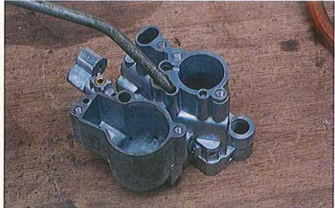
02.45 Soufflez à l'air comprimé tous les orifices et tous les passages d'air et d'essence et vérifiez le bon état et la propreté des filetages.
