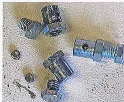
01.299 Reposez les câbles dans les réglers et remontez les arrêts de câbles (neufs de préférence). Les petits disques de métal se placent sur le câble entre celui-ci et l'arrêt de câble pour éviter de le couper. Le câble du frein arrière est arrêté par un écrou serrant sur une rondelle.
