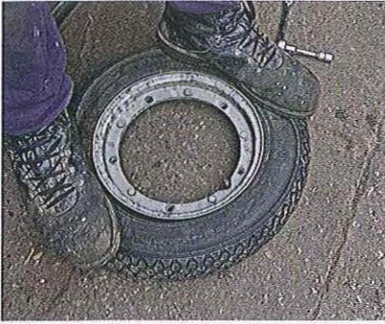
08.4 Si le pneu ne vient pas, faites porter votre poids le plus près possible du bord intérieur et alternez la poussée d'un pied sur l'autre.
