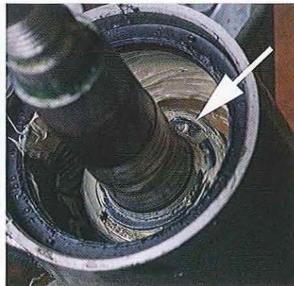
03.177 Il est muni du même circlip dans le logement sous la graisse.
