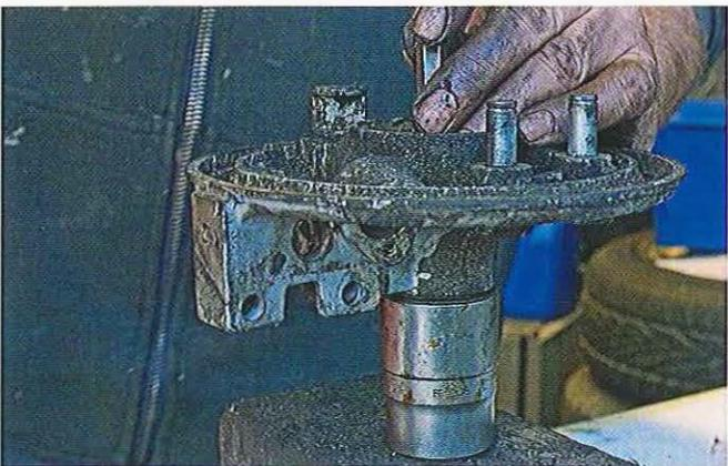
03.182 Pour sortir l'autre roulement, le flasque doit être posé sur un support creux comme une douille de grand diamètre.
