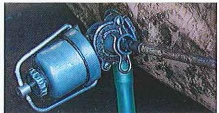
02.15 Les scooters les plus anciens (avant 1970 environ) sont munis d'un filtre décanteur à cuve en métal (ici) ou en verre. Dévissez l'écrou moleté et relevez l'étrier pour séparer la cuve du robinet.
