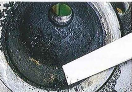
01.27 à gauche : les dépôts de calamine seront enlevés au moyen d'un outil non rayant (plastique dur taillé en biseau à 45 degrés, brosse en fil de laiton).
