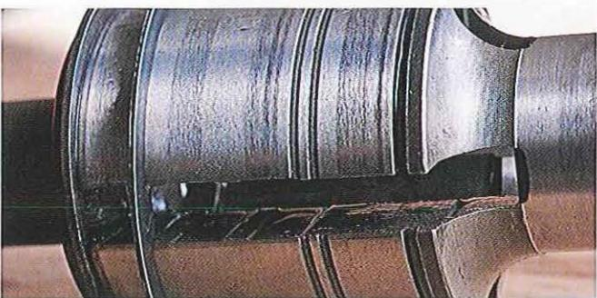
01.176 La rondelle de butée peut alors être retirée. Sur les boîtes EFL, on trouve un autre circlip ; sur les modèles pré-EFL, c'est un épaulement. Vérifiez l'état du manchon sur lequel tournent les pignons qui doit être exempt de rayures ou d'entailles. Seules des traces de frottement sont admissibles.
