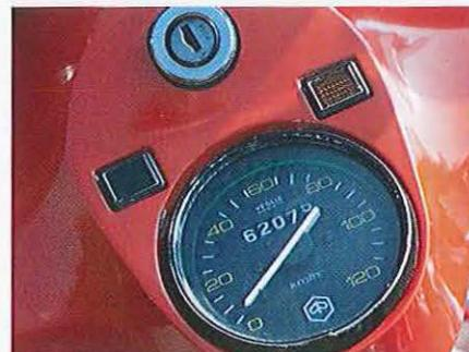
03.36 La Vespa PX type 1 est dotée d'un compteur circulaire sous un contact d'allumage à clé et deux témoins lumineux.
