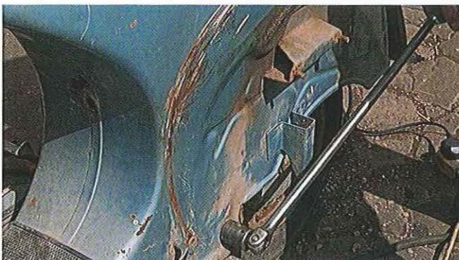
01.14 L'écrou de l'axe de fixation du bloc moteur sur la coque doit ensuite être desserré. Imbibez de dégrissant et utilisez une rallonge si nécessaire.
