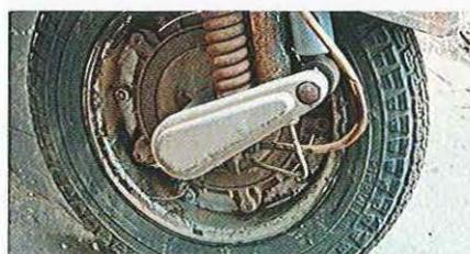
03.78 On voit ici l'ensemble de la roue avant du type Sprint avec la suspension et le moyeu. Très semblable aux types Rally, Super, etc. il a été maintenu en production jusqu'à l'introduction de la série P décrite plus loin.
