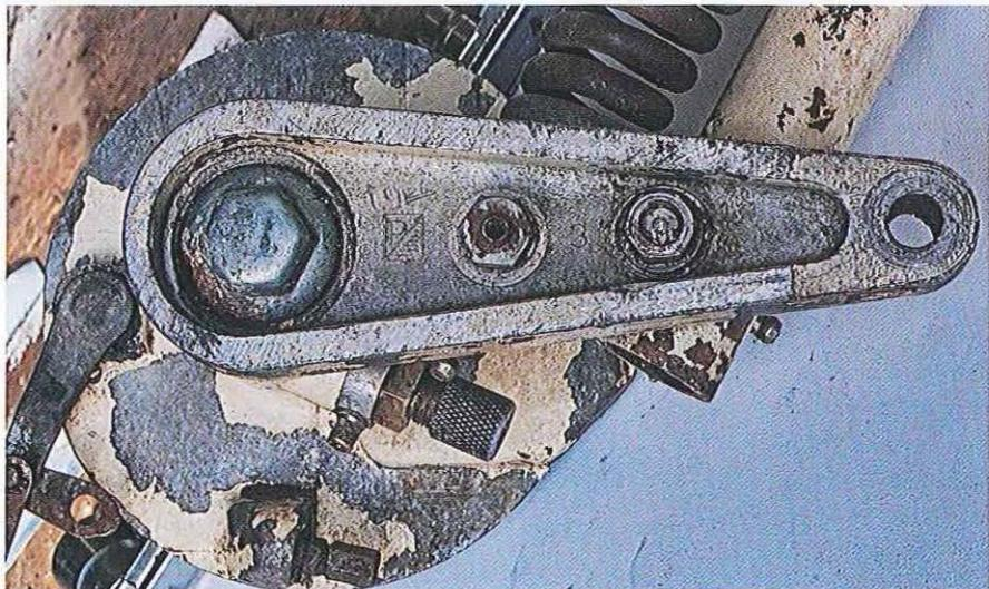
**03.106** Le système de la VBB est semblable à celui de la Sprint, mais avec des axes filetés avec écrous de retenue au lieu de pivots. Le démontage est très semblable.
