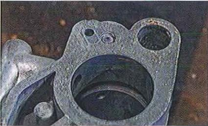
02.46 Si vous changez le carburateur, vérifiez la présence des trous de graissage automatique. On en trouve avec un trou dans la bride inférieure, mais sans le perçage de l'autre côté du volet de gaz.
