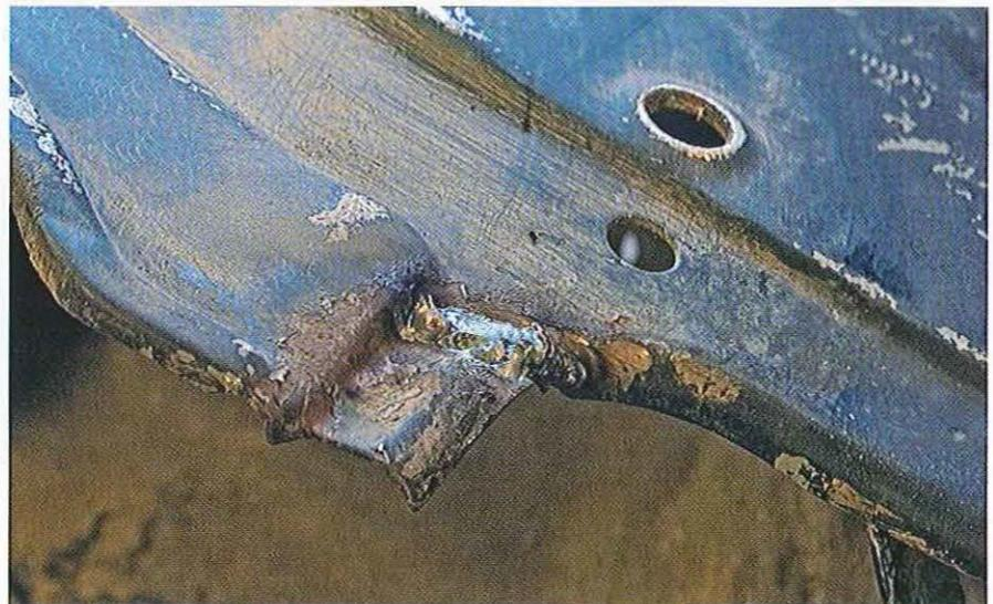
04.51 Déposez un petit cordon de soudure ou de brasure et meulez le dépôt de métal.
