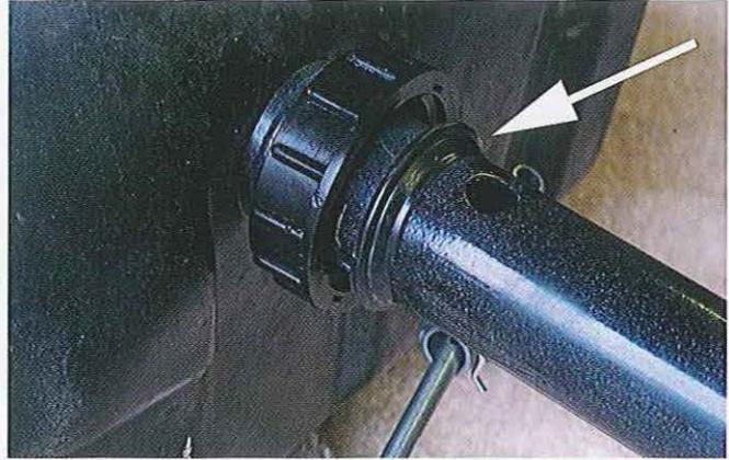
02.11 Il existe un autre joint (flèche) sous la bague supérieure. Vérifiez son bon état, sinon, remplacez-le.
