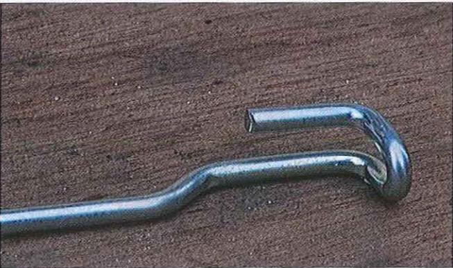
02.40 La tige de commande de gaz peut présenter des formes différentes ; celle-ci vient d'un moteur graissé par mélange. La tige des moteurs à graissage automatique est simplement coudée.
