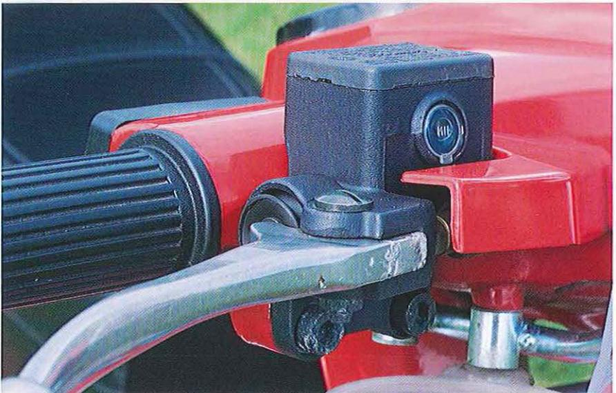
03.59 Les modèles à frein à disque sont pourvus d'un maître-cylindre fixé sur le capotage de tête de direction. Le niveau du fluide est visible par le regard circulaire transparent placé à l'avant du réservoir.
