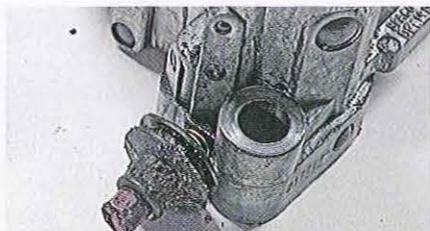
01.81 Le dégagement du carburateur de son boîtier peut poser problème sur les moteurs les plus récents car le réglage du ralenti s'effectue par cette tête de vis qui dépasse et qui traverse un joint très serré. Si le carburateur ne "vient" pas, repoussez le joint dans le boîtier avec un petit tournevis puis sortez le carburateur en le secouant.
