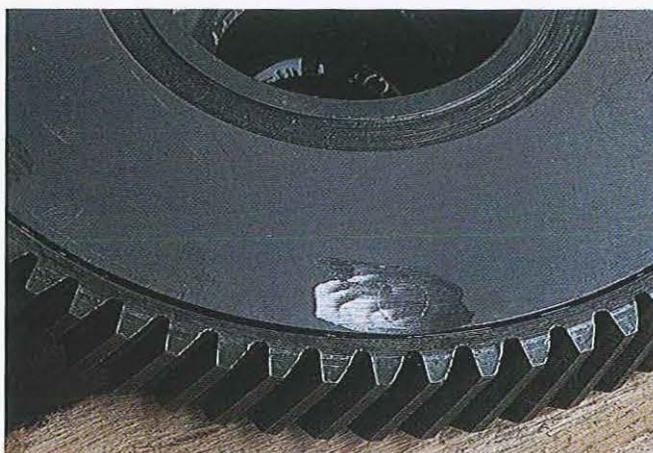
01.155 À l'intérieur du grand pignon, des ressorts absorbent les à-coups du couple moteur. Deux flasques rivetés retiennent les ressorts. Les rivets doivent être chassés par perçage, opération facilitée par le meulage préalable des têtes.
