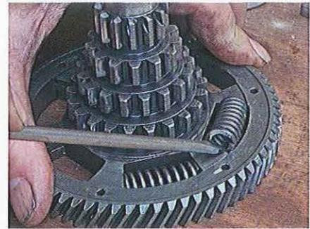
01.160 Les ressorts neufs sont insérés en faisant levier à l'inverse du démontage.
