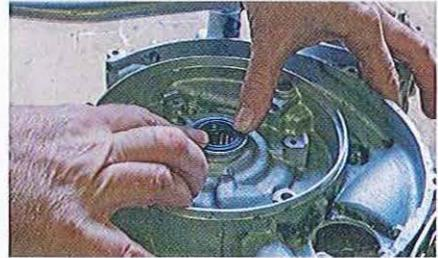
01.133 Lorsque le roulement est bien en place, vous pouvez monter le joint d'huile et l'insérer jusqu'à ce qu'il affleure la face du logement. Il peut rester en place jusqu'au montage du vilebrequin.
