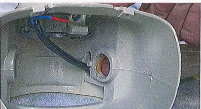
03.19 Après peinture, le capotage est prêt à être assemblé. Montez la plaque guide-câble et connectez les câbles électriques au boîtier des contacteurs.
