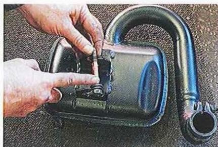
01.301 Graissez aussi le boulon qui tient l'échappement et qui rouille facilement en devenant difficile à desserrer et à percer.
