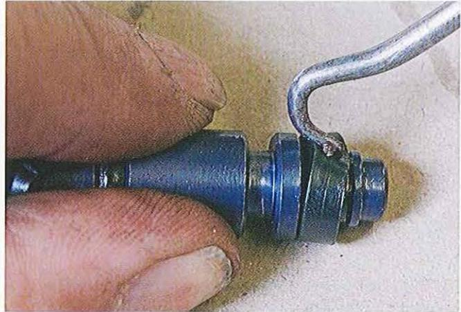
03.68 La coupelle et la bague se démontent facilement en les extrayant de leur gorge avec une petite pointe recourbée.
