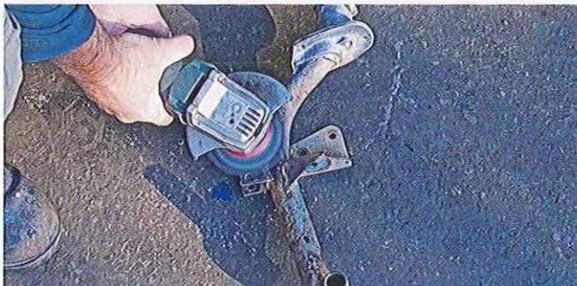
03.118 La colonne et la jambe de suspension avant sont ensuite nettoyées et préparées. Les filetages des écrous de blocage des roulements de colonne sont dérouillés puis la jambe inférieure est nettoyée à la brosse métallique rotative avant de recevoir une couche de peinture argent comme le flasque.
