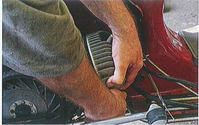
01.16 Après avoir chassé l'axe partiellement, supportez le moteur par le cylindre et retirez totalement l'axe.
