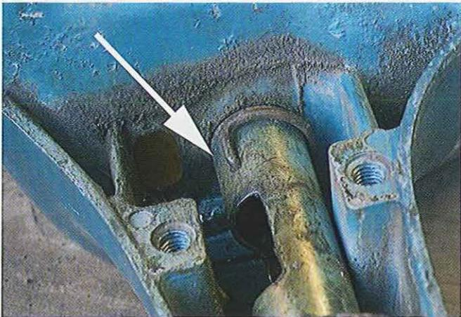
03.11 Démontez ensuite les tubes de commande (flèche) fixés par des goupilles en épingle. Un tournevis suffit à les écarter.
