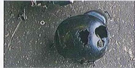
01.23 Le carénage peut être détaché de la culasse. Examinez-le pour d'éventuels dommages. Il doit être entier et exempt de fissures pour assurer sa fonction. S'il est cassé, il doit être remplacé.
