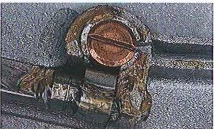
01.238 Le plongeur en laiton du couvercle d'embrayage doit être remplacé si la fente centrale est trop endommagée ou déformée. Celle-ci est réutilisable. Pour la remplacer, tournez simplement le levier de commande de l'embrayage, et la bague sort.
