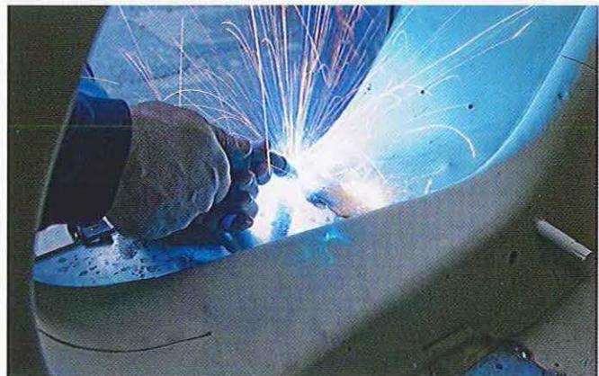
**04.29** Une fois le plancher fixé, revenez à l'avant et effectuez une série de petits cordons pour combler le joint. Alternez d'un côté à l'autre pour éviter que l'excès de chaleur ne déforme les tôles.
