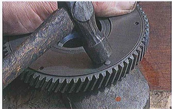
01.162 Frappez la tête du premier rivet qui traverse les deux flasques, l'ensemble reposant sur un support bien stable. Ne matez pas le rivet avant d'avoir inséré tous les autres dans les perçages bien alignés et vérifié l'absence de jeu entre les flasques.
