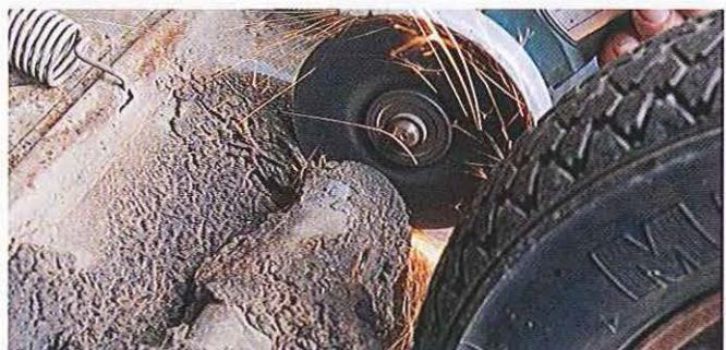
01.20 Avec un disque à tronçonner plasma monté sur une meuleuse d'angle, coupez le corps du boulon. L'espace est généralement suffisant pour sortir le moteur en le secouant sans pratiquer une seconde coupe de l'autre côté.
