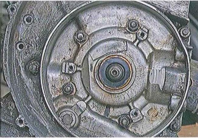
01.50 Les moteurs avant la série P présentent un aspect différent avec un bossage plus large autour de l'axe de vilebrequin, bien visible après dépose du stator.
