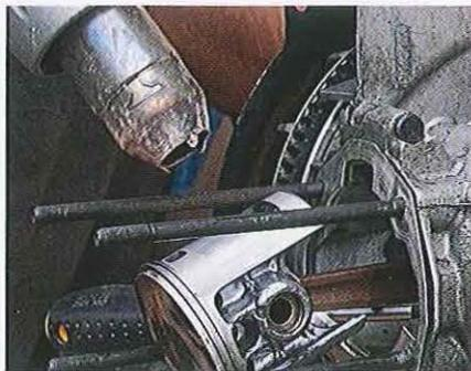
01.35 Démontez un seul circlip pour l'instant puis chauffez le piston autour de l'axe (avec un sèche-cheveux par exemple). On peut alors chasser l'axe du piston avec une broche ou un tournevis adapté. Si l'axe résiste, remontez en partie le cylindre pour soutenir le piston et frappez légèrement sans marquer l'axe. Sans support du piston, la bielle peut être endommagée.
