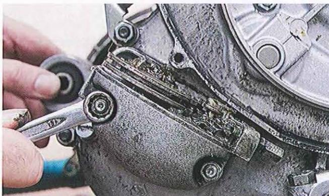
01.277 Le guide se glisse dans l'extrémité de la tige de sélection - opération délicate - puis l'ensemble est mis en place en affleurant le boîtier avant de serrer les écrous.
