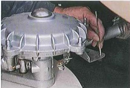
03.157 Si l'on utilise un garde-boue neuf, celui-ci n'est peut-être pas livré avec les perçages pour les fixations latérales. Dans ce cas, montez les fixations supérieures puis avec un marqueur, tracez les emplacements des trous à percer sur les côtés.
