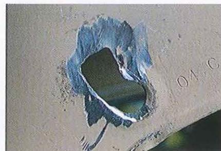
04.54 Avec une lime, éliminez le métal endommagé ou rouillé et découpez si possible une section carrée qui facilitera la repose d'une pièce de tôle neuve.
