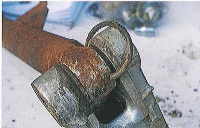
03.199 Les joints détruits de l'articulation du bras ont laissé passer l'eau et les poussières qui ont accéléré l'usure de l'axe et des roulements.
