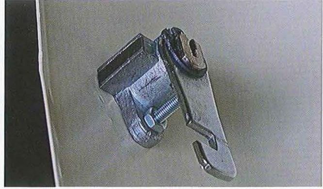
07.66 Sur certains modèles anciens, des rivets retiennent l'ensemble du loquet (des boulons sur certaines Motovespa). Ces boulons doivent être recoupés en longueur.
