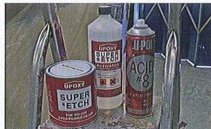
04.4 Une tôle d'acier doux fraîchement décapée commence à s'oxyder très vite, même quand elle est stockée au sec. Passer une couche de primaire mordant (d'accrochage) acide est une bonne idée. Le produit existe en aérosol comme en bidon pour une application traditionnelle au pistolet.
