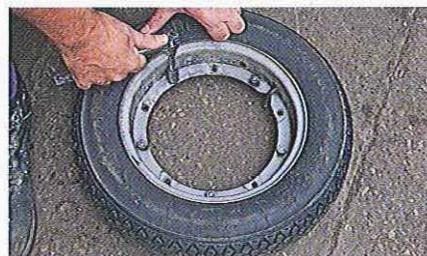
08.1 Le remplacement d'un pneu commence par le dégonflement partiel suivi du démontage des écrous de jante souvent de 13 mm et parfois de 14 mm.
