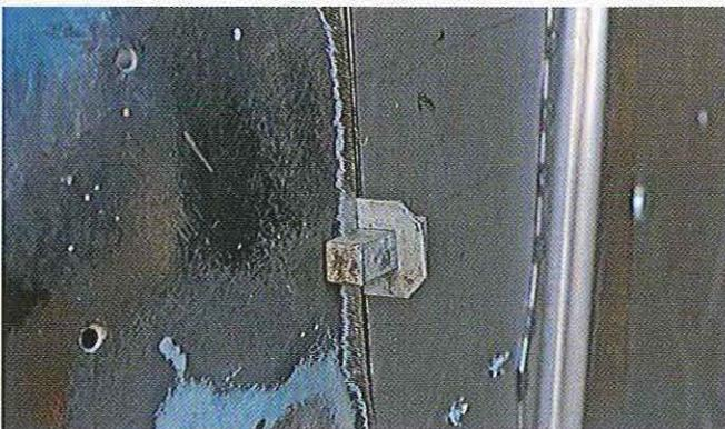
04.25 Le plancher neuf peut être retenu sur les bords avec une pince-étau, mais ces fixations Intergrrip sont idéales pour le tenir en place au milieu de la coupe. Elles tiennent aussi les tôles suffisamment écartées pour laisser pénétrer la quantité de soudure nécessaire.
