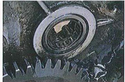
01.116 Sur les tout premiers moteurs type VBB, le roulement de l'arbre secondaire comporte quatre types de pièces.
