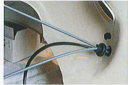
04.86 Remplacez à chaque passage de câble dans la tôle les protections en caoutchouc usagées par des neuves.
