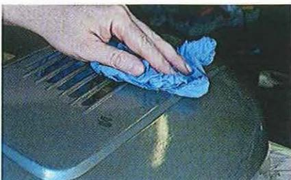
**05.6** Certaines pièces de tôlerie neuves ont été livrées simplement graissées et non traitées au primaire, ce qui pose un vrai problème. Nettoyez-les avec un dégraissant spécial et essuyez-les soigneusement avec du papier absorbant fréquemment renouvelé.
