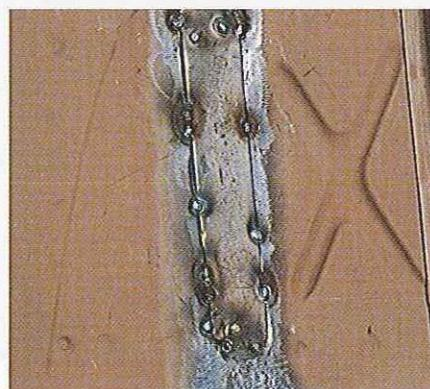
04.43 Faites quelques petits cordons de soudure sur les bords et deux bouchons sur le tunnel.
