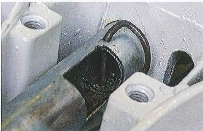
03.22 Assemblez les deux parties du tube et posez la goupille en épingle après avoir aligné les trous avec un petit tournevis.
