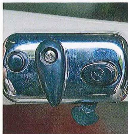
**06.15** Les anciens contacteurs sont robustes, mais en cas de défaillance, il faut les remplacer. On se méfierait de la qualité des pièces de refabrication.
