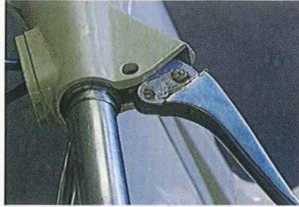
03.28 Les câbles se montent en les alignant sur les ouvertures du levier puis en les couplant à l'équerre. Le montage n'offre pas de difficulté particulière. Graissez bien le pivot du levier et n'oubliez pas les rondelles avant de remettre le levier en place et de remonter le pivot.
