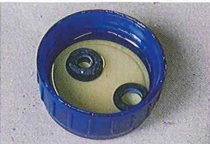
03.71 Laissez tremper les pièces en caoutchouc dans du fluide de frein neuf pendant deux minutes avant de les remonter.
