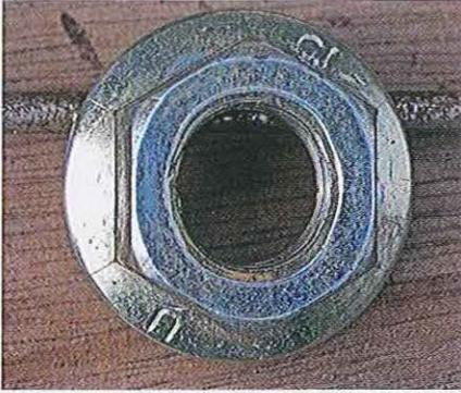
01.63 En examinant l'écrou, celui-ci paraît déformé, mais sa géométrie est correcte car sa forme ovale assure son blocage automatique. Mais il est possible que l'usine ait monté un écrou normal (M12) et une rondelle éventail.
