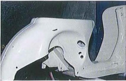
**05.20** Quand on ne dispose pas d'un support spécial, peignez d'abord le dessous de la coque, laissez sécher et durcir puis passez aux surfaces supérieures.
