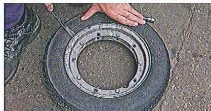
08.3 Essayez de détacher le petit côté de la jante. Celle-ci peut être collée sur le pneu. Tirez très fort, sinon insérez prudemment un démonte-pneu pour décoller le pneu progressivement. Si le pneu est inutilisable, vous pouvez être plus agressif avec l'outil.
