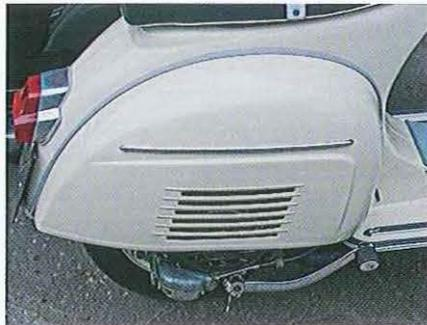
04.74 Il est souvent préférable de monter des capots neufs : tout dépend du budget, du temps et de la disponibilité de ces pièces. Des capots neufs existent pour les modèles VBB, Super, Sprint et PX tous types.
