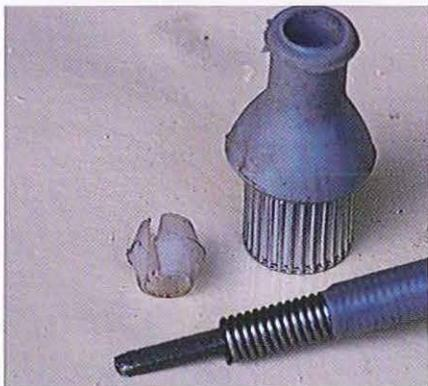
03.160 La dernière opération consiste à passer le faisceau de fils dans la fourche. Le câble du compteur doit d'abord être démonté et reconditionné. L'embout en plastique à gauche se déboîte simplement, suivi de la bague crantée et du cache en plastique.
