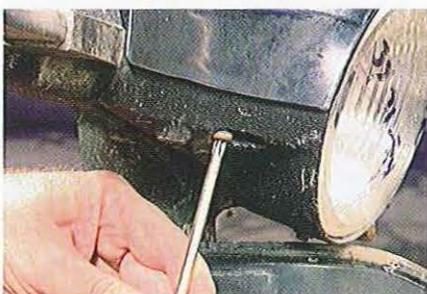
03.39 Toutes les versions possèdent un capotage en deux parties. Les quatre vis de retenue sont accessibles par le dessous.
