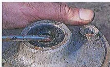
03.109 Retirez le joint qui recouvre le roulement de fusée côté tambour.
