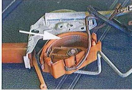
06.17 Les émetteurs de jauge subissent l'usure au niveau du rhéostat (flèche) qui ne peut être réparé. Les émetteurs neufs ne sont pas très chers.
