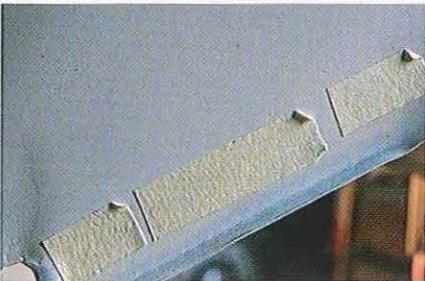
**05.18** Certains propriétaires préfèrent que le numéro de coque ne soit pas recouvert par la laque. Si c'est votre cas, protégez-le par de l'adhésif avant de peindre et retirez la protection avant que la peinture ne soit sèche. Si elle est laissée jusqu'à séchage complet, il y a risque d'arracher la couche avec l'adhésif.
