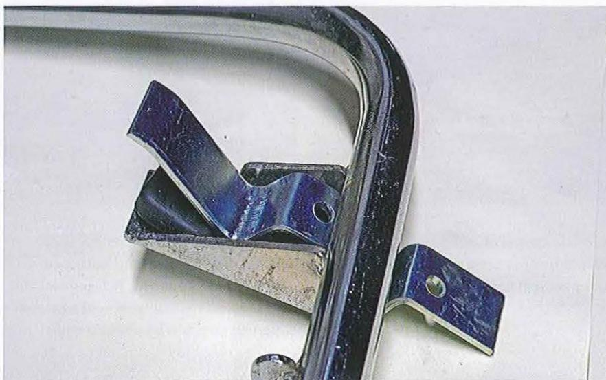
07.52 Les arrêts de béquille sont de simples pièces coudées en acier. Il faut graisser le support de béquille régulièrement dans le cadre des opérations d'entretien courant. Les scooters à roues de 8 pouces (type VBB - pas les Super) ont un seul boulon de fixation et non pas deux comme ici. Les kits de fixation de béquille comprenant des boulons en Inox sont préférables.
