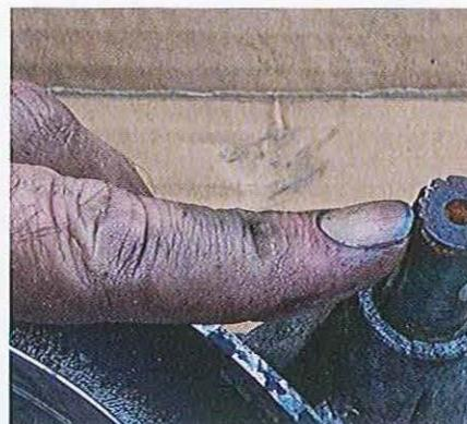
01.191 Le levier du kick et l'axe sont à cannelures et celles-ci diffèrent selon les modèles. Par exemple, un levier de VBB ne s'engagera pas sur ces cannelures de PX.
