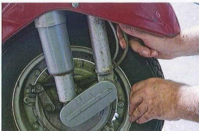
03.40 Une fois les vis retirées, poussez le câble du compteur à partir de la roue vers le haut pour soulever la partie supérieure du capotage.
