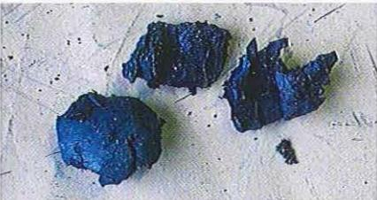
01.295 Les vieilles bagues caoutchouc peuvent se briser au lieu de sortir. Les résidus peuvent être brûlés avec une lampe à souder. Si le tube en acier reste bloqué, essayez un dégrissant et la chaleur. En cas d'échec, il faut confier le travail à un atelier disposant d'une presse. La repose des bagues, identique à celle de la série P décrite ci-dessus, s'effectue au moyen de douilles et d'une tige filetée pour appliquer la force nécessaire à l'insertion.
