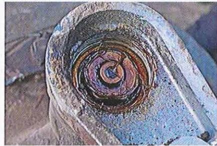
**03.105** ... qui révèle un second écrou de 22 mm qui doit céder sous l'effet d'une clé à Impact. Si vous utilisez une douille et un cliquet, remontez le tambour sur l'axe et immobilisez-le pour démonter cet écrou.
