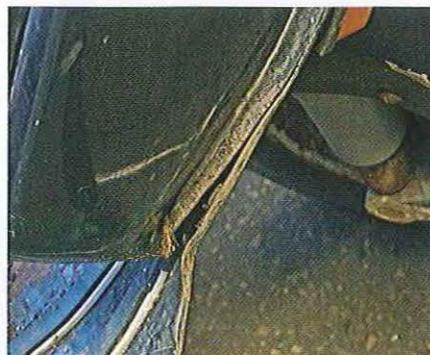
04.57 Le rebord du tablier est très souvent endommagé, notamment lorsque le scooter glisse sur le côté après une chute.
