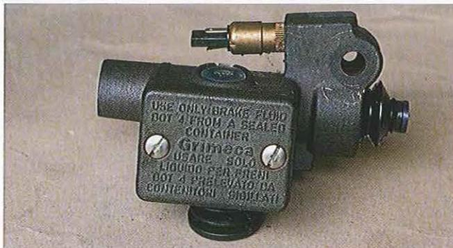
03.75 Des vis neuves en acier inox sont à conseiller. Plus solides, elles résistent mieux à la corrosion que les vis originales.
