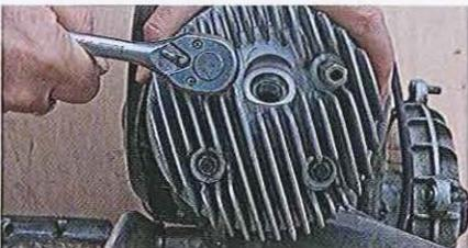
01.24 Les écrous de retenue de la culasse font 11 mm sur plats pour les moteurs 125/150 cm<sup>3</sup> et 13 mm pour les 200 cm<sup>3</sup>. Le desserrage des écrous doit se faire (moteur froid) par quarts de tour et en croix pour relâcher la tension progressivement et régulièrement.
