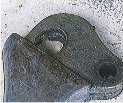
03.27 Vérifiez les points sujets à usure : pivots, serre-câbles et arrêts de câbles, etc.
