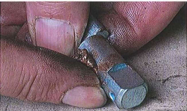
03.140 Mettez un peu de graisse cuivrée sur le point fixe du frein et glissez-le dans le flasque.
