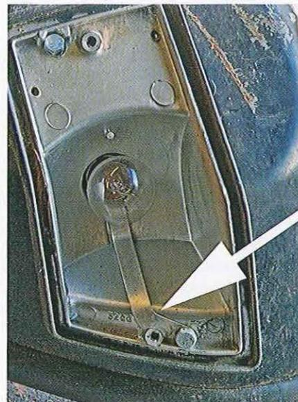
**06.13** Les blocs arrière sont mis à la masse par ces barrettes qui se relient à une connexion boulonnée (flèche) souvent corrodée, d'où problème.
