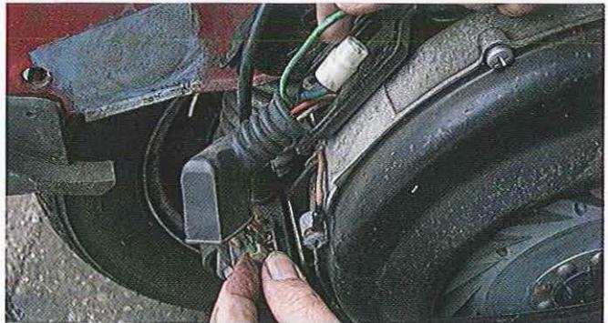
01.6 Ouvrez le boîtier de raccordement électrique, séparez le connecteur ou desserrez les vis de fixation (selon le modèle), puis relevez le cache en caoutchouc sur la bobine et détachez les fils.
