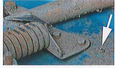
**03.82** Sous le garde-boue, on découvre d'autres écrous dont les têtes des boulons correspondants sont sous l'habillage latéral en aluminium (s'il y a lieu). Ils doivent être démontés aussi, ce qui suppose le dévissage de deux écrous de 7 mm (flèche).
