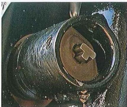
04.98 La bague de blocage se présente ainsi. Elle est située juste après la prise électrique. Elle peut être tournée et extraite avec une pince à becs longs, mais l'opération est souvent difficile. Utilisez du dégrissant et secouez la pièce qui finira par sortir. Le barillet bloqué peut être extrait par ce côté avec un outil approprié.
