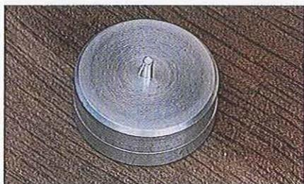
01.253 Si vous envisagez de supprimer le système de graissage automatique (cas du montage d'un moteur plus récent que le scooter), la meilleure méthode consiste à insérer un bouchon obturateur spécial dans le passage de l'arbre d'entraînement de la pompe.
