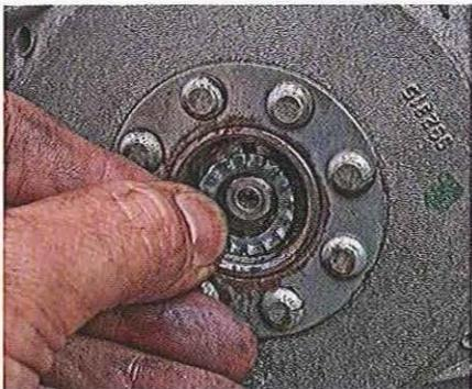
01.42 Une fois le volant immobilisé, dévissez l'écrou et retirez la rondelle élastique.
