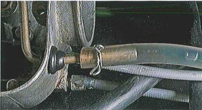
01.5 Pour le tuyau d'arrivée d'huile, retirez le collier et détachez le flexible. Préparez un boulon ou un bouchon à insérer dans le tuyau pour limiter l'écoulement de l'huile.
