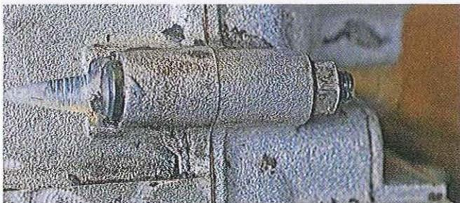
01.83 Desserrez progressivement les écrous des boulons de carter et retirez les boulons. Rangez-les dans l'ordre pour faciliter leur remontage ultérieur.
