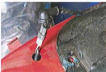
**02.2** Si une jauge est installée, le connecteur du fil est sous un cache en caoutchouc. Une fois le cache extrait de la coque, tirez le connecteur et débranchez-le.
