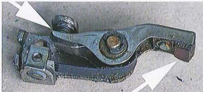
**06.24** Les languets de contact ne sont pas chers ; remplacez-les systématiquement lors d'une restauration. Les faces de contact (flèche de gauche) doivent être nettoyées avant le montage car un vernis protecteur est souvent appliqué en fabrication. Cette extrémité en plastique porte sur le volant magnétique. Le feutre de graissage (flèche de droite) est intégré au stator. Vérifiez qu'il est imbibé d'huile sinon le talon du languet sera vite usé.
