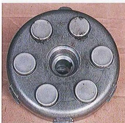
01.201 Jusqu'à l'apparition de la version Cosa, l'embrayage monté sur la majorité des séries se présente ainsi avec six (moteurs 125/150) ou sept (moteurs 200 ou T5) cuvettes de ressort.
