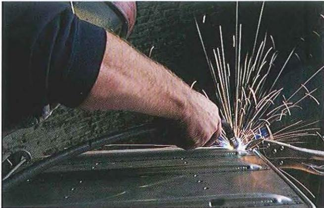
**04.26** Deux petits bouchons de soudure de chaque côté tiendront l'avant en place tandis que le reste du plancher sera soudé en place. Vérifiez à nouveau vos repères d'alignement.
