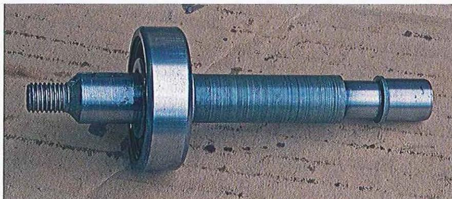
01.153 L'arbre sort avec le roulement en place.
