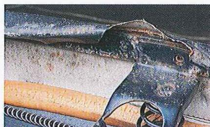
07.35 L'ancien revêtement roulé sous la carcasse se détache ou se coupe au couteau pour aller plus vite.
