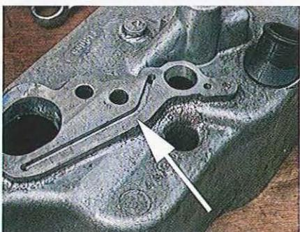
01.256 Sur les moteurs à graissage automatique, le dessous du boîtier comporte un passage d'huile (flèche) qui alimente le carburateur. Le boîtier sera nettoyé et si vous décidez d'appliquer une pâte d'étanchéité sur le plan de joint, vérifiez que ce produit n'obstrue pas le passage de l'huile dont l'absence dans le mélange carburé mènerait à la destruction du moteur.
