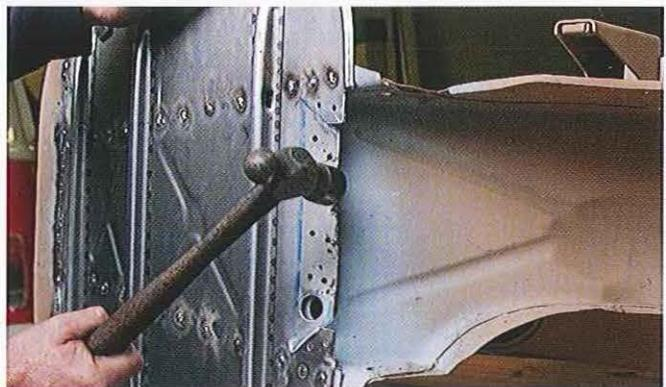
**04.31** À l'arrière, les rebords peuvent être repliés après avoir été percés pour réaliser les soudures en bouchon.
