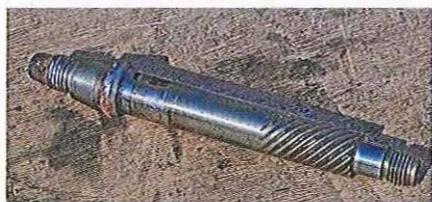
03.107 L'axe (fusée) sort à travers le moyeu à partir du côté de l'écrou de 22 mm. Un chambrage usiné est prévu pour centrer mieux un outil à chasser.
