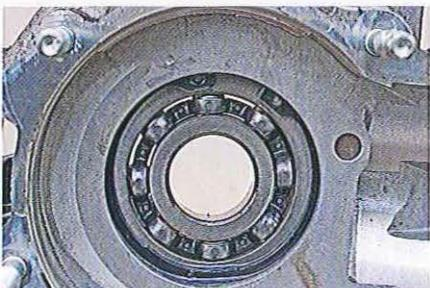
01.103 Le roulement côté embrayage est retenu par un circlip. Enlevez-le et retournez le carter.
