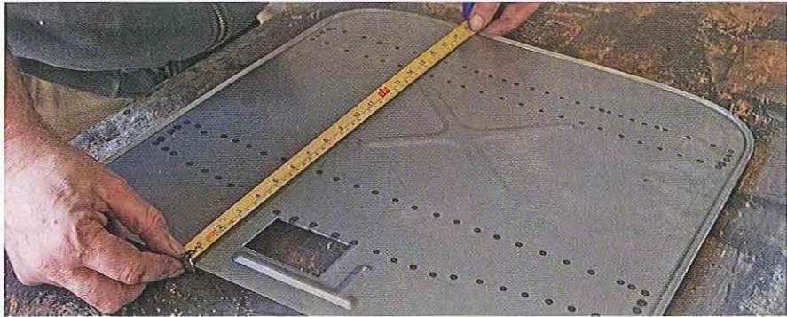
04.10 Des planchers emboutis de rechange sont disponibles pour tous les modèles à distributeur rotatif et coque large. Celui-ci, peu coûteux, provient du Vietnam. Les pièces équivalentes d'origine italienne, préformées à l'arrière, sont presque trois fois plus chères. Mesurez le nouveau plancher avec précision à partir d'un point précis du plancher arrière.
