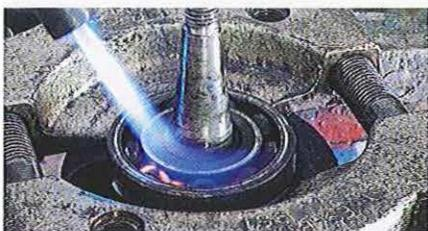
01.144 Deux boulons rapprochent les portées biseautées qui décollent et écartent le roulement. Autre méthode : placez le vilebrequin sur un étau ou un support, réchauffez la bague intérieure du roulement et chassez le vilebrequin en frappant l'extrémité protégée de la fusée avec un maillet à tête souple ou en bois.
