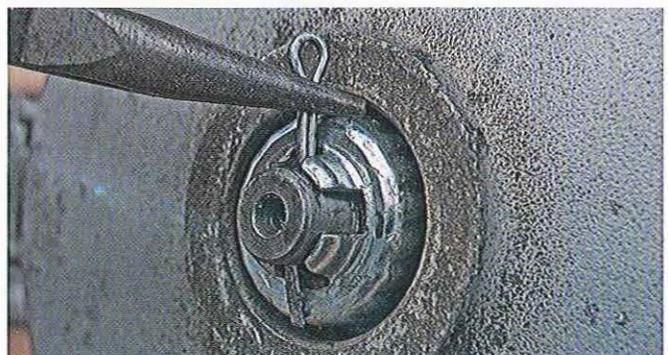
01.68 Retirez la goupille fendue et le cache de protection et desserrez l'écrou crénelé.
