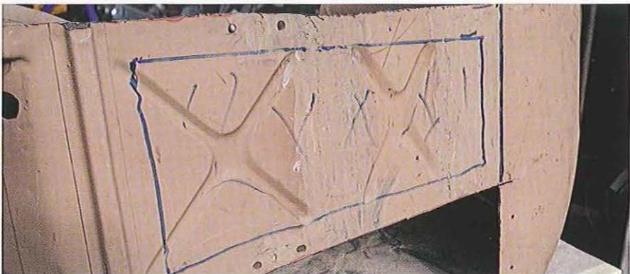
04.13 Le plancher de part et d'autre du tunnel a été découpé. Il est conseillé de procéder par tronçons afin de réduire les contraintes sur la tôle laissée en place et donc les déformations. La partie centrale sous le tunnel est repérée approximativement en vue de sa découpe.
