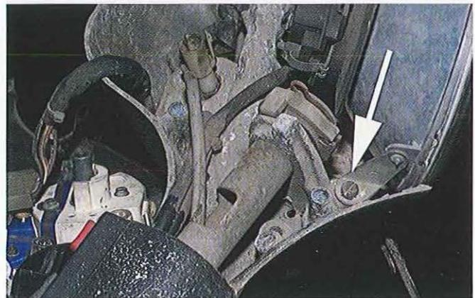
03.44 Notez la position et l'orientation de tous les fils électriques et de tous les câbles. Le phare est retenu par une vis de chaque côté (flèche).
