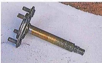
03.108 Sur un scooter VBB ou similaire doté d'un moyeu à quatre goujons, la méthode de démontage est identique, mais l'axe vient avec le flasque.
