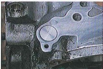
01.254 Appliquez une fine couche de produit d'étanchéité sur le rebord du bouchon et poussez-le en place.
