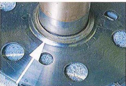
01.213 Il existe une rondelle de butée en laiton à la base de l'arbre central (flèche). À remplacer après avoir noté son orientation.
