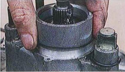
01.241 Les joints du flasque de moyeu arrière – un grand joint, un plus petit et deux joints jumelés – doivent être remplacés.
