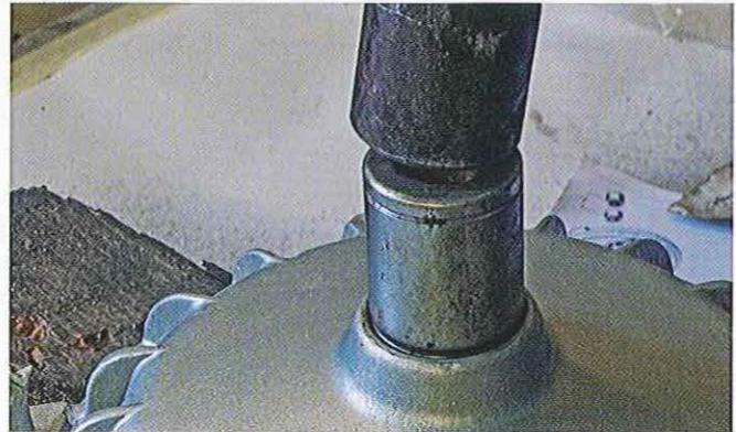
03.195 Les roulements du tambour peuvent ensuite être montés avec une chasse appropriée portant bien sur la cage extérieure des roulements.
