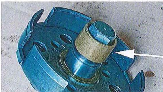
01.214 La grande bague en laiton (flèche) s'extrait facilement et, sauf parfait état, elle doit être impérativement remplacée.
