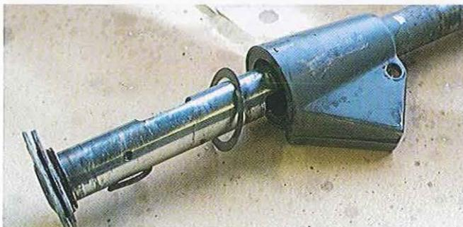
03.18 Dégraissez les tubes avant peinture. Si l'opération est repoussée à plus tard, assemblez-les pour éviter de perdre les petites pièces comme les rondelles entretoises côté sélecteur de vitesse ; vérifiez l'état des embouts de câble qui doivent être exempts de déformations et celui des poulies-guides d'enroulement.
