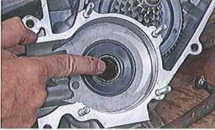
01.146 Avant d'insérer la soie du vilebrequin, graissez l'entrée du roulement pour éviter un démarrage à sec, puis graissez la lèvre du joint d'huile.
