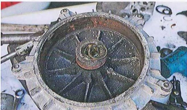
03.187 L'autre roulement est derrière un joint à lèvres qu'il faut soulever.
