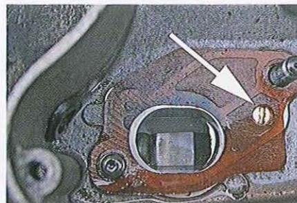
01.82 Le boîtier du carburateur est fixé par cette unique vis (flèche) qui peut être masquée par le joint. Desserrez-la et enlevez le boîtier complet avec la pompe à huile (s'il y a lieu).
