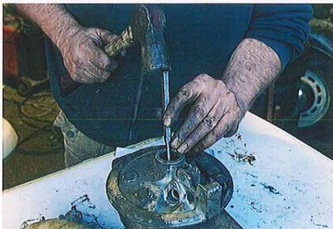
03.181 Utilisez un chasse-goupille mince car la portée n'est pas large pour chasser les roulements de leur logement dans le flasque. De ce côté, c'est plus facile car le roulement peut tomber sous le flasque.
