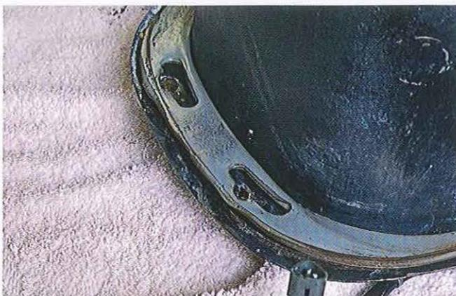
02.5 Sous le rebord du réservoir existe un joint de caoutchouc ou de nylon selon l'année du scooter. Déposez-le pour l'examiner. Ne l'oubliez pas au remontage.
