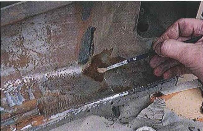
04.18 L'intérieur du tunnel peut être rouillé. Dans ce cas, poncez à la toile émeri gros grain. Appliquez ensuite un antirouille pour prévenir toute corrosion ultérieure.
