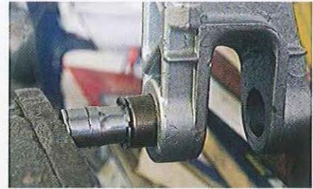
03.206 La première bague à aiguilles peut être insérée avec une douille portant sur la cage intérieure, pas sur les pétales. Les bagues sont plus faciles à insérer qu'à extraire.
