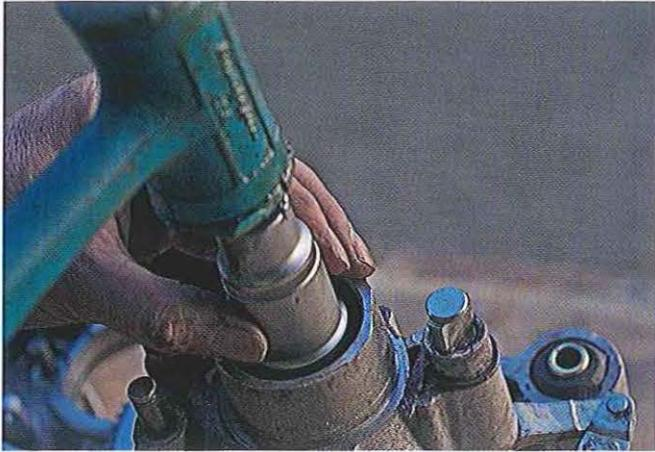
**01.185** Remontez ensuite le roulement de l'arbre secondaire. Si le moteur est muni d'un joint intérieur, insérez le joint d'abord à fond avant de chasser le roulement en place. Remontez le circlip ou la bague de retenue du roulement et le joint.
