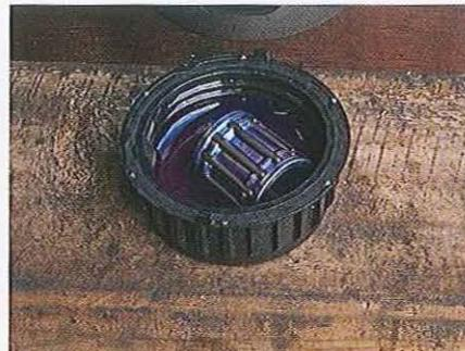
01.264 Faites tremper le roulement de pied de bielle dans de l'huile deux temps et insérez-le dans la bielle.
