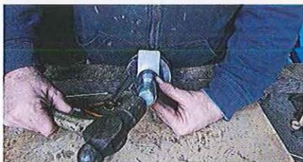
01.141 Le coin-support et la cale-entretoise étant en place, insérez vite la bague réchauffée sur le vilebrequin. Avec l'outil à chasser, frapper la bague jusqu'à la cale en bloquant le vilebrequin pour absorber les chocs.
