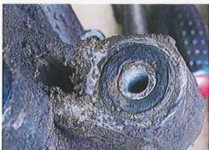
01.278 Vérifier l'état de l'articulation (silentbloc) de l'amortisseur arrière (usure, déformation) : généralement, la bague caoutchouc émerge de la douille lorsqu'elle est avachie.
