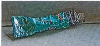
05.13 Une fois bien séchée, l'état de la surface doit être encore vérifié. Il est rare d'obtenir un travail parfait à ce stade où l'on trouve toujours de très petites imperfections telles que des marques de ponçage ou de petites bulles d'air dans le mastic. On les élimine avec un stopper ou mastic de finition, produit celluloseux facile à appliquer et bon marché.
