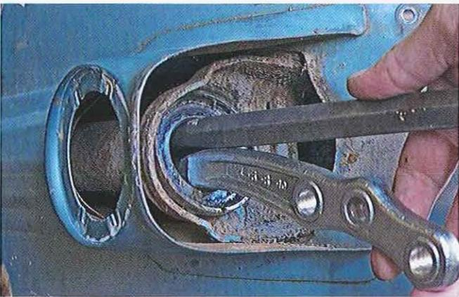
03.252 La cuvette inférieure est plus difficile à traiter car le rebord est masqué par l'embouti de la coque. En passant un doigt derrière le roulement, vous sentirez un petit espace libre qui sert précisément à extraire la cuvette. Une griffe d'extracteur calée par un morceau de métal adéquat suffira en principe. Trois mains seraient apparemment préférables, mais vous pouvez y parvenir tout seul.
