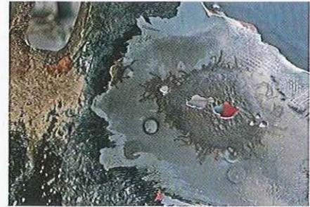
04.47 Ces trous se situent à la courbure du tablier derrière la roue avant, endroit souvent attaqué par la rouille.
