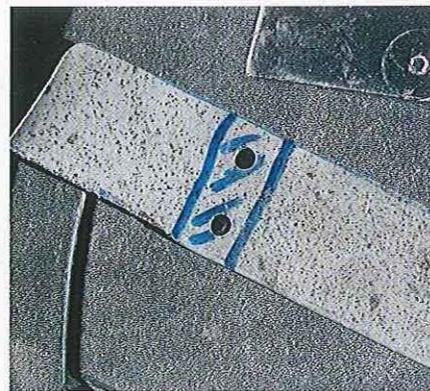
04.40 Une fois la tôle découpée, repérez la partie en contact avec le tunnel et percez deux trous pour souder en bouchon.
