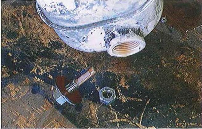
02.10 Une fois desserré, l'écrou est libre ; remontez un joint neuf sauf si le joint ancien est en parfait état.
