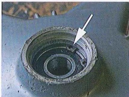
03.185 Le moyeu à disque ou à tambour porte sur deux roulements : le premier est retenu par un circlip qu'il faut extraire (flèche).
