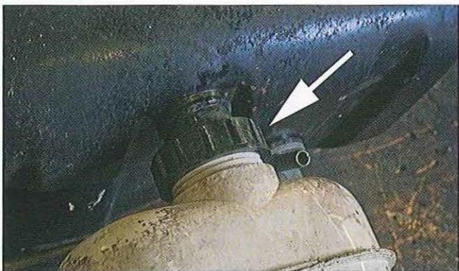
02.8 La dépose du réservoir d'huile commence par le démontage de cette bague fileté en plastique.
