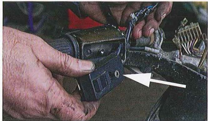
03.50 Les contacteurs sont retenus par une seule vis à tête fraisée.
