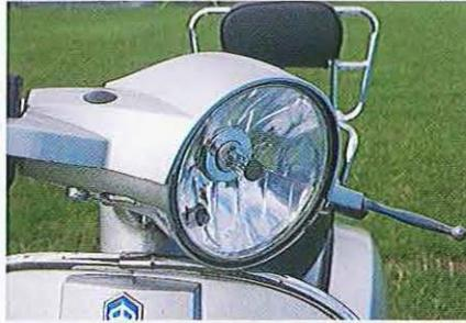
06.7 Les PX à frein à disque furent équipés d'un phare halogène. Ce type d'éclairage peut être monté *a posteriori* sur les scooters de la gamme EFL pour autant qu'on puisse utiliser le faisceau secondaire du phare. Ne touchez jamais le verre des ampoules halogènes mais seulement l'embase en métal.
