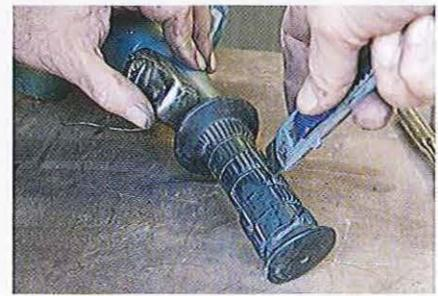
**03.7** Le meilleur moyen de retirer les vieilles poignées en caoutchouc non réutilisables consiste à les fendre avec un cutter et à les arracher.
