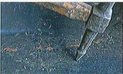
04.62 Commencez par marteler le métal contre un tas ou une surface dure en observant la réaction du métal aux impacts.
