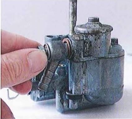
**02.22** Tous les carburateurs des moteurs à distributeur rotatif ont sensiblement la même architecture et sont interchangeables, car les fixations n'ont pas varié pendant toute la production. Le raccord banjo d'arrivée – s'il n'a pas été démonté au début du processus de restauration – doit être dévissé en notant la présence d'un grand joint en fibre contre le corps du carburateur et d'un plus petit sous la tête du six-pans. Ces rondelles devront être remplacées par des neuves.
