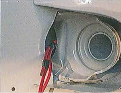
**06.2** La mise en place du faisceau électrique est facilitée par le passage préalable d'un fil d'aiguillage. Celui-ci peut quand même buter sur le renfort intérieur de la coque. Dans ce cas, insérez-le vers le bas de la coque par le logement de l'avertisseur et jusqu'à l'emplacement du réservoir puis le long de la colonne de direction depuis le haut, reliez les deux sections et tirez jusqu'à obtenir une seule longueur de fil d'aiguillage sur toute la longueur de la coque.
