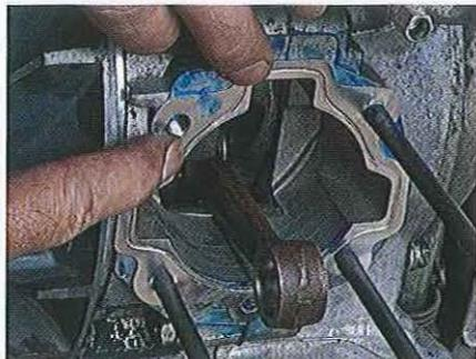
01.262 Appliquez un produit d'étanchéité sur le plan de joint du carter où des fuites peuvent se produire. Positionnez le joint d'embase (fragile car généralement en papier).
