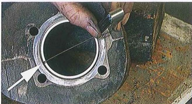
01.271 Utilisez le piston pour vérifier le bon positionnement des segments dans le cylindre et enfoncez-le de 20 mm environ. Les segments étant bien droits, mesurez le jeu à la coupe (flèche) avec des cales d'épaisseur ; le jeu doit être compris entre 0,25 et 0,40 mm. Si le jeu est trop faible, meulez ou limez les becs jusqu'à obtenir le jeu normal.
