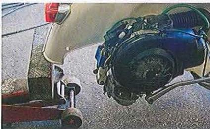
01.298 Supportez l'arrière de la coque. Graissez abondamment le boulon de l'axe avant de l'insérer. Cet axe est à remonter en premier avant de fixer le boulon de l'articulation inférieure de l'amortisseur.
