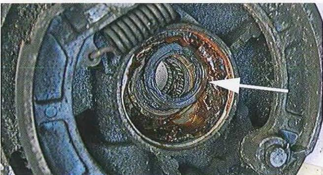
03.180 La rondelle libre sera probablement noyée dans la vieille graisse. Les deux roulements du tambour dans le flasque sont bien visibles.
