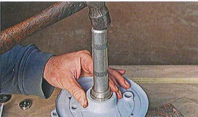
03.127 Montez le roulement avec un outil à chasser du diamètre approprié car celui-ci est monté serré. Quand il portera bien dans son logement, le bruit du marteau deviendra mat. La gorge du circlip devra être bien dégagée. Montez le circlip. Le second roulement sera monté par l'arrière, là encore avec une chasse du bon diamètre...
