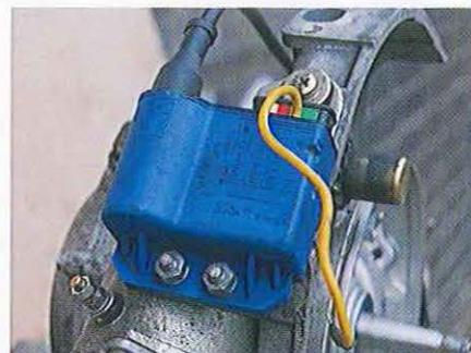
**06.37** Les allumages électroniques ont un boîtier ou bloc de ce type à la place du bobinage. Le fil jaune est une mise à la masse qui se corrompt souvent et casse, mais le bloc peut continuer à fonctionner sans ce fil.
