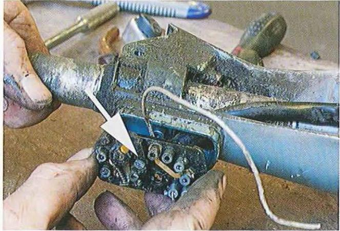
03.10 La partie intérieure du boîtier des contacteurs est retenue par une autre vis (flèche) qu'il faut retirer.
