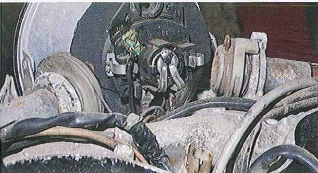
03.43 Le couvercle étant retiré, on accède à tous les composants. Notez la corrosion visible de la prise de masse du porte-ampoule (défaut courant).
