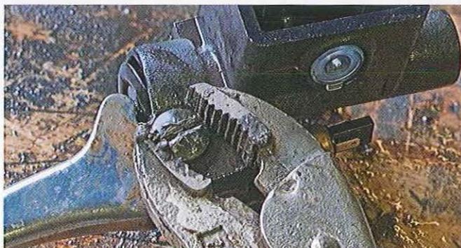
03.64 La vis du pivot du levier souvent corrodée et bloquée peut imposer l'utilisation d'une pince-étau car la fente de la tête trop tendre se déforme facilement.
