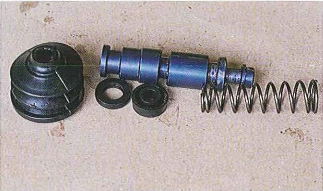
03.69 Vérifiez que le piston déséquipé est exempt de bavures au niveau des coupelles avant de remonter les pièces neuves.
