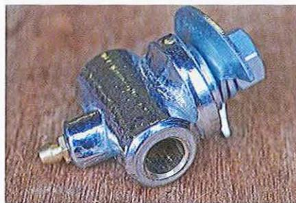
**03.131** Le pivot neuf d'articulation du ressort est muni d'une bague au lieu de roulements : moins cher à produire, il est probablement plus robuste à condition d'être bien graissé.
