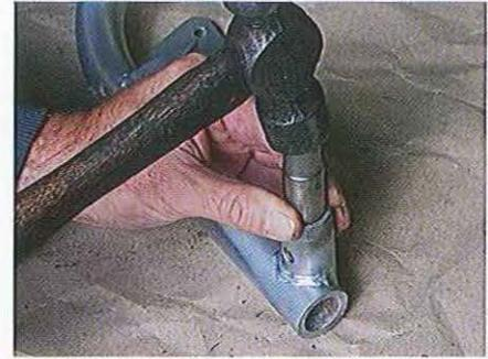
03.123 Insérez ensuite une rondelle dans le tube et poussez-la en place.
