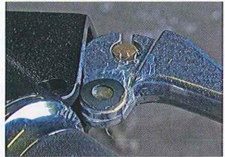
03.58 Graissez le levier et placez une rondelle élastique au-dessus et une rondelle plate au-dessous, puis glissez le levier en place.
