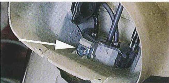
03.26 Alignez le capotage avec la roue avant afin que tous les composants soient correctement orientés puis encastrez-le en tapotant légèrement avec la main. Insérez la vis dans le logement supérieur de la colonne de direction puis dans l'écrou (flèche) inséré par le dessous qu'il faut immobiliser à la main jusqu'au commencement du vissage. Serrez au couple entre 3 et 4 mkg.
