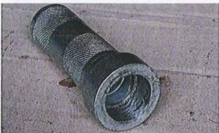
01.140 La bague sera mise en place avec cet outil (bon marché) mais on peut utiliser un morceau de tube en aluminium du bon diamètre qui fera le même travail.
