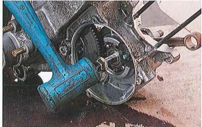
01.90 Avec un maillet à tête souple, chassez le vilebrequin du carter. S'il semble bloqué, chauffez légèrement la cage intérieure du roulement et essayez encore. Sur les moteurs anciens, chauffez le carter pour extraire le roulement avec le vilebrequin. Leur séparation s'effectuera plus tard.
