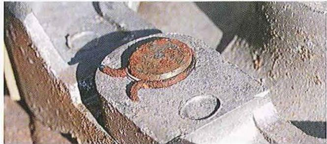
**03.92** Les deux mâchoires pivotent sur le même point fixe, retenues par un clip en fer à cheval qui se retire en écartant ses extrémités. Ces clips élastiques peuvent échapper brusquement et traverser l'atelier.
