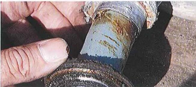
**03.86** Il faudra quelques coups secs pour dégager la cuvette à billes. Frapper régulièrement et diamétralement sur tout le pourtour en prenant soin de ne pas la mettre en biais et de ne pas marquer l'aluminium sous le cache, ce qui obligerait à rectifier la portée ultérieurement. Dès que la cuvette a bougé, sa dépose devient facile. Une fois séparée du carter en aluminium, elle est totalement libre et peut être enlevée sans outil.
