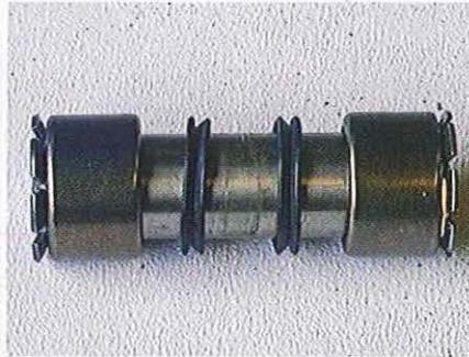
03.205 L'axe-pivot neuf doit être accompagné des joints d'étanchéité neufs.
