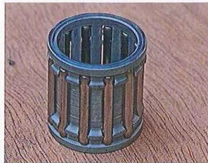
01.36 Le roulement de pied de bielle est libéré après démontage de l'axe de piston. Vérifiez l'absence de rayures/piqûres et le jeu des rouleaux, mais le remplacement systématique est conseillé lors de chaque démontage du haut moteur.
