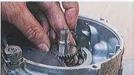
01.235 Insérez la clavette demi-lune dans le vilebrequin, suivie de l'entretoise, ici à dents car il s'agit d'un moteur à graissage automatique. Vérifiez que l'engrènement avec le pignon menant est correct.
