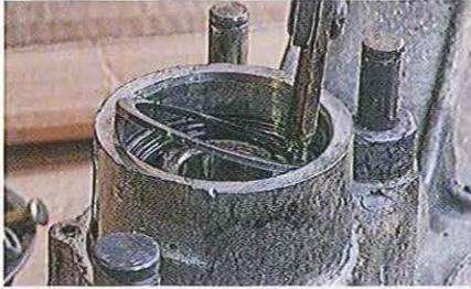
01.111 Le circlip placé au-dessous doit être extrait aussi.
