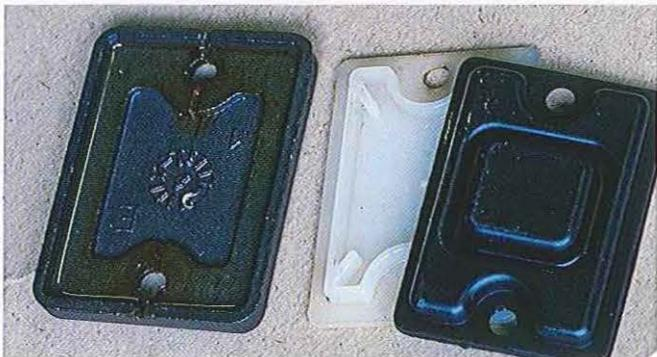
03.74 Le joint de couvercle (à gauche) comprime la membrane en nylon (au centre) et s'imprime dans le couvercle (à droite).
