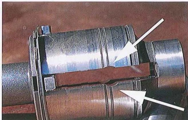
01.173 La tige de sélection sort en laissant le croisillon en place. Si le scooter est un des derniers PX (EFL et après), les ouvertures fraisées dans le manchon de l'arbre comportent des découpes semi-circulaires (flèches).
