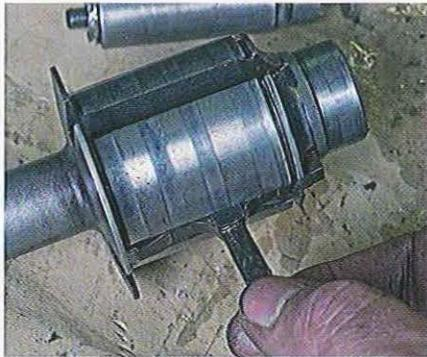
01.179 Il s'extrait en utilisant sa propre section arrondie au lieu des découpes du manchon, mais le principe reste le même.
