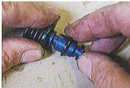
03.72 Le soufflet cache-poussière peut être remonté côté levier, les deux autres joints côté cylindre. Le joint arrière peut être roulé jusqu'à sa gorge de retenue, la coupelle est glissée en utilisant du fluide de frein comme lubrifiant.
