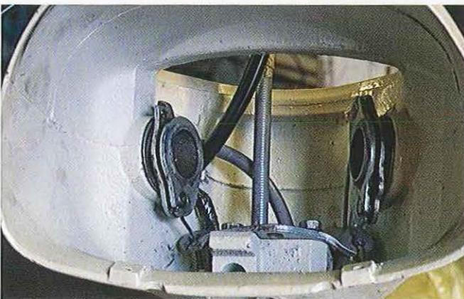
03.24 Posez simplement le capotage sur la colonne et replacez les câbles et le faisceau électrique.
