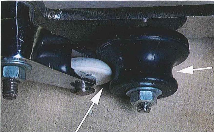
**07.58** La moulure est prise entre ces deux molettes (flèche). La molette de droite porte sur le bord extérieur du tablier, la gauche presse la moulure en place. La pose commence par le haut. On obtient difficilement un fini régulier dès la première passe et il faut souvent procéder à plusieurs passes d'outil.
