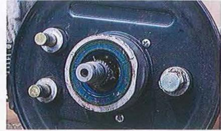
01.243 Le joint du moyeu arrière peut alors être remplacé (ou le cache-poussière sur un scooter plus récent bien que le joint cache-poussière en métal puisse être remplacé si l'on veut par un joint en caoutchouc de type ancien). Vérifiez les cotes du joint à changer : soit 27 x 47 x 6 mm, soit plus récemment (après 1983 environ, mais les dates peuvent varier) 30 x 47 x 6 mm. Les dimensions sont moulées dans le caoutchouc.
