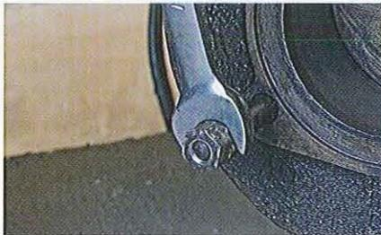
01.31 Il arrive souvent que le cylindre collé au carter refuse de venir. Pour enlever les goujons, bloquez deux écrous l'un sur l'autre sur chaque goujon puis desserrez l'écrou inférieur qui extraira le goujon du carter et du cylindre. Une fois les quatre goujons sortis, le cylindre se séparera plus facilement du carter. Si le piston est grippé dans le cylindre, lubrifiez et attendez que la tension entre piston et vilebrequin se relâche après enlèvement des goujons.
