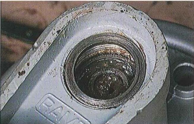
03.138 Montez la grande entretoise puis l'écrou de retenue (au besoin en montant provisoirement le tambour pour le bloquer lors du serrage de l'écrou).
