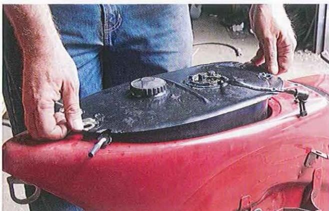
02.4 Levez le réservoir verticalement et inclinez-le pour dégager le levier du robinet de l'ouverture de la coque.
