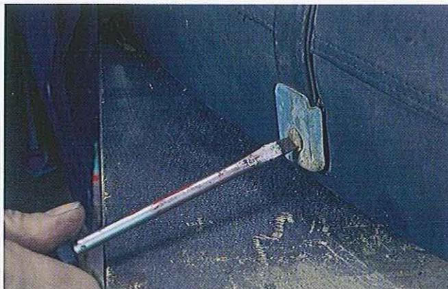
07.32 Les sangles de la selle sont fixées à l'intérieur de la selle par des platines et des vis. Ces vis sont aussi souvent bloquées.
