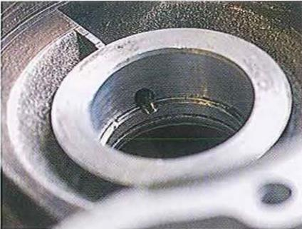
01.131 Le roulement porte sur un épaulement étroit, usiné, dans le logement.
