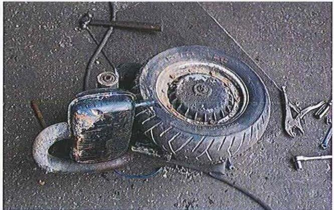
01.18 Si vous préférez, l'échappement et la roue peuvent être laissés en place pour le moment. Dans ce cas, le moteur peut être sorti après dépose de l'axe de retenue et du boulon d'amortisseur.
