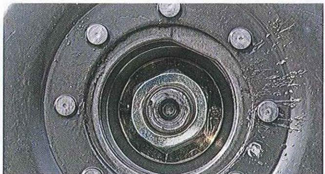
01.62 L'embrayage des versions Cosa, monté sur les modèles PX à frein à disque, est dépourvu de rondelle d'arrêt et d'écrou à créneau mais équipé d'un écrou apparemment normal.
