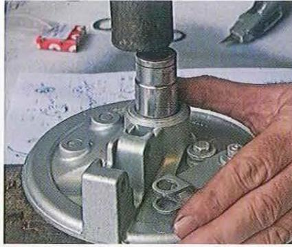
03.192 Utilisez une douille du diamètre le plus proche de celui du roulement pour le mettre en place (il existe des outils spéciaux si vous préférez). Posez les roulements.
