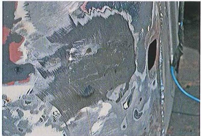
04.48 Un morceau de tôle a été découpé et soudé en place selon la même technique que celle appliquée au plancher.
