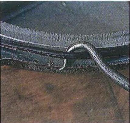
01.239 La lèvre du couvercle porte un grand joint torique en caoutchouc à remplacer par un neuf.
