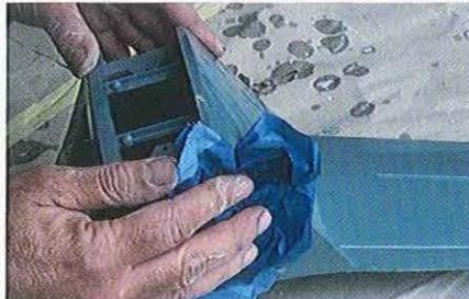
**05.21** Les pièces en plastique neuves doivent être totalement dégraissées avant peinture.
