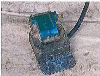
**06.36** Les systèmes conventionnels comprennent de simples bobinages. Les versions de la période des VBB peuvent être protégées par des caches en plastique. Ils sont tous fixés de la même façon.
