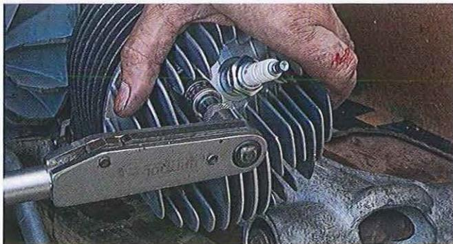
01.274 Chaque goujon de culasse reçoit une rondelle plate, une rondelle élastique et un écrou. Utilisez une clé dynamométrique et serrez les goujons progressivement et en croix. Le manchon fileté, servant à fixer la coiffe canalisant l'air, se monte sur le goujon supérieur droit.
