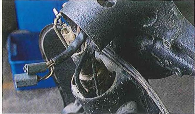
03.48 La vis de blocage du capotage sur la colonne peut ensuite être retirée et l'ensemble soulevé après démontage des câbles de commande, ou leur sectionnement s'ils sont trop détériorés pour être réutilisés.
