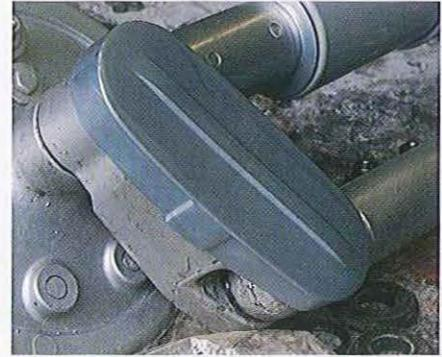
03.221 Un nouveau cache de bras oscillant peut être monté – en plastique sur les PX et peu cher. Il en existe des modèles décoratifs.
