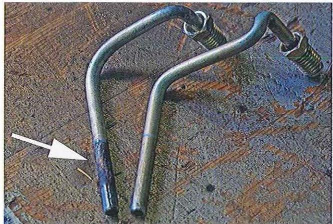
02.50 Vérifiez l'état du tuyau d'huile à son entrée dans le boîtier du carburateur. En cas de corrosion évidente, remplacez-le avant qu'il ne commence à fuir.
