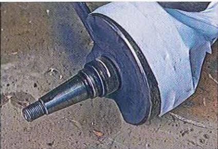
01.134 Pour démonter la bague intérieure d'un vilebrequin type PX, faites deux fentes diamétralement opposées en veillant bien à ne pas marquer le vilebrequin. Protégez l'embellage avec du papier et du ruban adhésif pour éviter de projeter des débris dans le roulement de tête de bielle.
