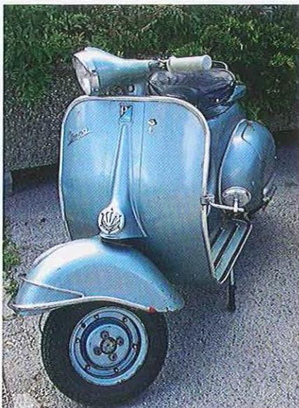
Le type VBB est facilement identifiable par ses roues de 8 pouces, ses coffres latéraux très bulbeux et son tablier large.
