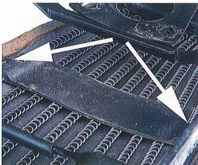
07.37 Sur certains modèles (PX) on trouvera une base en plastique sous la mousse. Dans ce cas, retirez la sangle de fixation agrafée sous les ressorts.
