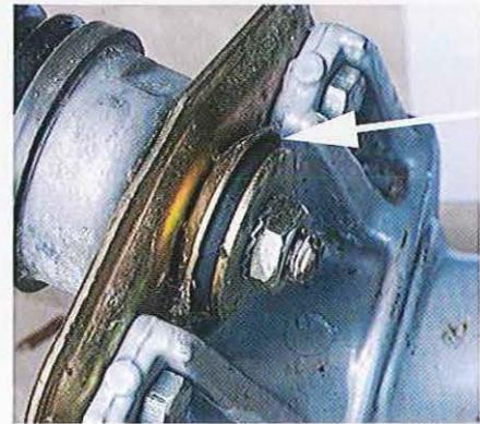
03.215 L'amortisseur peut alors être remonté avec des silentblocs neufs.
