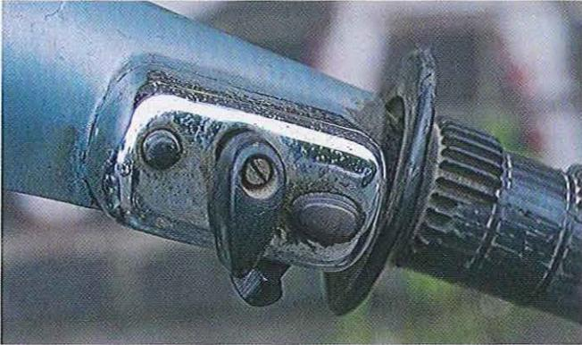
03.9 Le contacteur d'éclairage se démonte avec son câblage. Retirez la vis centrale et la manette puis le cache chromé simplement enfoncé. Le contacteur inférieur en plastique doit être en position centrale pour pouvoir retirer le cache.
