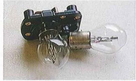
03.29 Les ampoules existent en différentes puissances homologuées pour l'usage routier. Choisissez les modèles appropriés à votre scooter, notamment au niveau de la tension (6 ou 12 volts). Si le porte-ampoules est à remplacer, procurez-vous un modèle d'origine car les connecteurs des modèles bon marché ne donnent pas un bon contact.
