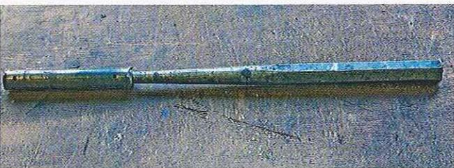
**03.248** La colonne étant déposée, il reste à démonter les cuvettes des roulements. Il existe des outils spéciaux, mais un long jet en métal tendre peut être utilisé en frappant légèrement et alternativement sur deux points diamétralement opposés pour ne pas incliner la cuvette.
