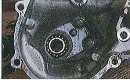
01.112 Le roulement qui doit être chassé de l'intérieur exige une broche plus longue et des précautions avec le marteau.
