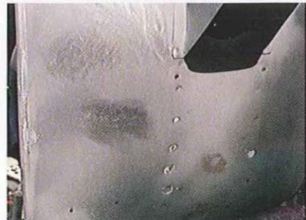
**04.1** Le sablage fait gagner du temps sans être efficace à cent pour cent. Des plaques de peinture peuvent subsister, par exemple dans les creux des points de soudure. Il y a aussi risque de gondoler des tôles peu rigides comme le tablier si l'impact du jet d'abrasif est trop puissant.
