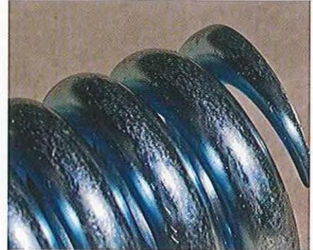
03.150 Ce ressort produit par Stoffi (fournisseur autrichien), taré 33 pour cent plus ferme que le type standard, ce qui réduit la plongée au freinage, est aussi mieux fini que les modèles bon marché.
