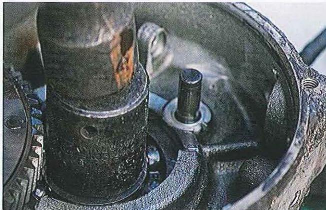
01.106 Utilisez une douille du diamètre de la bague intérieure du roulement. Chauffer doucement la zone du carter entourant le roulement est une bonne méthode car elle desserre légèrement la cage extérieure. La même méthode est à employer sur les anciens carters pour extraire le roulement qui peut être très serré.
