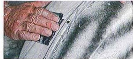
05.11 Poncez légèrement le guide avec du papier grain 600, très mouillé et lubrifié avec un peu de savon liquide. Notez la position des doigts qui doivent être perpendiculaires au sens du mouvement pour éviter de creuser des sillons dans la surface.
