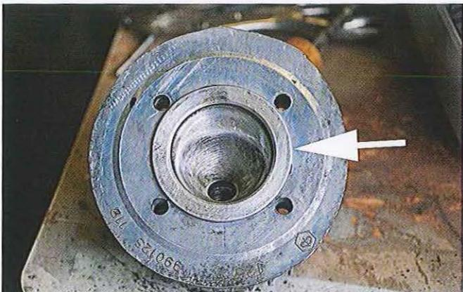
01.273 La culasse aura été décalaminée et nettoyée (polie). La portée assurant l'étanchéité (flèche) sera intacte et parfaitement plane (voir 01.27 - p. 14).
