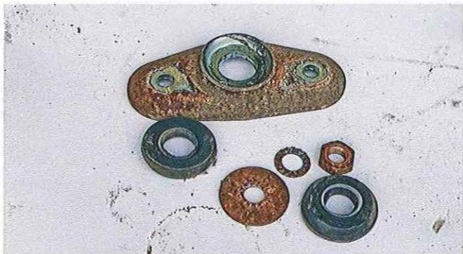
03.170 L'amortisseur porte une platine d'ancrage supérieure qu'on peut démonter pour nettoyage et remplacement des deux bagues isolantes ou silentblocs en caoutchouc. La tige de l'amortisseur porte une fente permettant de l'immobiliser pour dévisser l'écrou.
