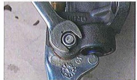
03.73 Le piston réassemblé est inséré dans le cylindre et retenu par le levier. Le remontage du pivot peut être un peu délicat du fait de la pression du ressort sur le levier, mais l'opération n'a rien de difficile. Un écrou autobloquant type Nyloc arrête le pivot ; vérifiez que le serrage ne bloque pas le fonctionnement du levier.
