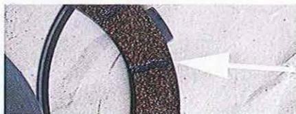
01.224 Les garnitures de liège seront aussi examinées pour en estimer l'usure en mesurant l'épaisseur au niveau des fentes.
