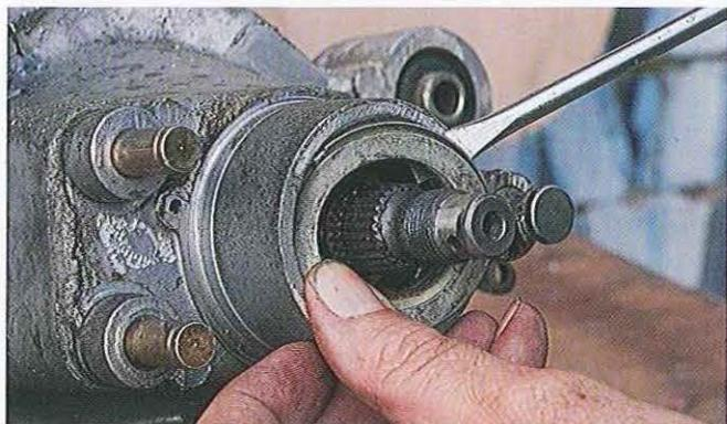
01.75 Sur les PX EFL ultérieurs, on trouve une rondelle cache-poussière car le joint torique des autres modèles a été reporté à l'intérieur. Soulevez soigneusement le cache qui peut être réutilisé s'il est intact. S'il existe un joint caoutchouc, retirez-le avec le cache.
