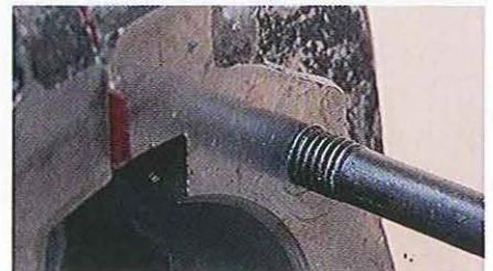
01.261 Vérifiez l'état de surface du plan de joint de l'embase du cylindre qui doit être impeccable. Si les goujons ont été démontés ou remplacés, appliquez un liquide frein sur les filets préalablement vérifiés et dégraissés pour mieux les tenir en place.
