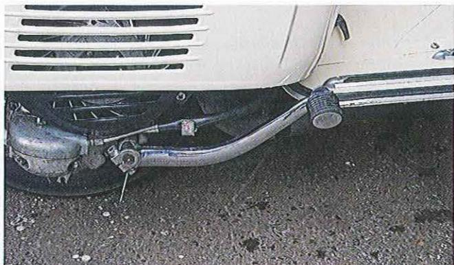
01.192 Des kicks accessoires ont des cannelures modifiées. Ce levier recourbé style Sprint est en réalité monté sur un moteur PX afin de donner au scooter un air rétro.
