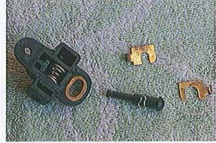
06.18 Les contacteurs de stop pré-PX fonctionnent avec deux plaquettes mises en contact. Le soudage des fils en place est préférable aux connecteurs obus.
