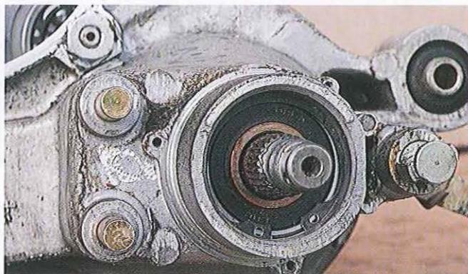
01.76 Sous le cache-poussière se trouve un roulement étanche. Le joint d'huile de l'arbre de sortie est derrière le roulement (comme indiqué précédemment) et si ce montage offre une meilleure étanchéité à l'huile, et donc limite les risques de contamination des garnitures de frein, le remplacement du joint impose le démontage du groupe. Si un joint caoutchouc est placé devant le roulement, ce dernier n'est pas du type étanche, mais ouvert et graissé par l'huile de la boîte.
