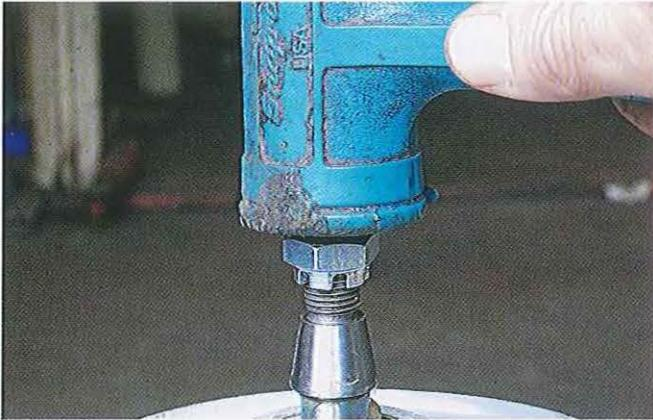
03.136 Revisez l'écrou à l'avant, dépassant un peu le filetage pour le protéger ainsi que le trou de goupille, puis chassez l'axe en place avec un maillet souple.
