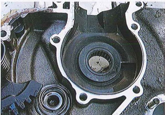
01.107 Le roulement côté volant est du type à aiguilles sur la série P.
