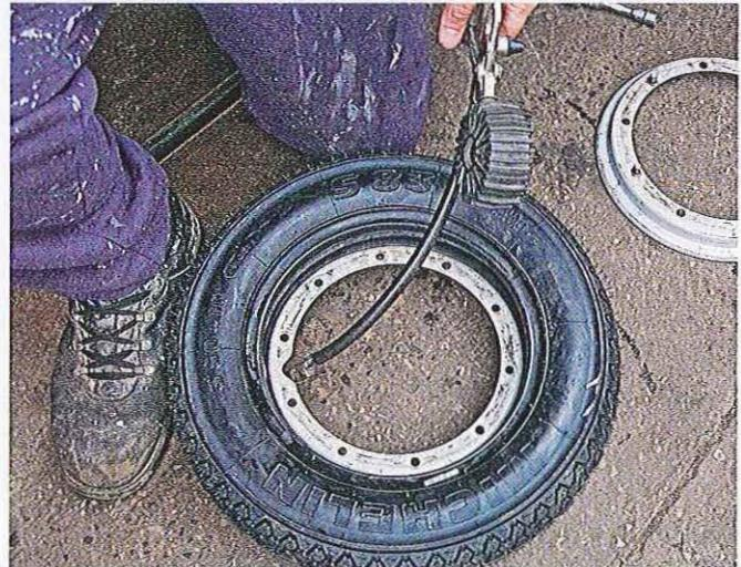
08.8 Gonflez légèrement pour une bonne mise en place et pour empêcher le pincement de la chambre en montant l'autre partie de la jante. Vérifiez la bonne position de la valve dont on doit voir émerger le corps recouvert de caoutchouc. Au gonflage, maintenez-la tant que la pression n'est pas suffisante pour la retenir.
