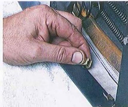
07.40 Le revêtement doit être modérément tendu jusqu'à ce que les bords soient enroulés sur la carcasse, sinon il formera des faux plis. Le revêtement doit être fourni avec des clips neufs.
