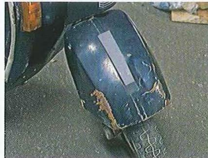
04.75 Des éléments comme les garde-boue ne justifient pas toujours le temps nécessaire à leur réparation notamment quand ils sont dans cet état. Les rechanges ne sont pas chers bien qu'ils nécessitent parfois des travaux de finition (perçages notamment) avant montage.
