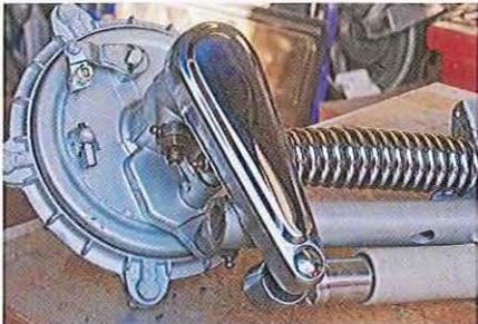
03.156 Le cache neuf du bras oscillant est en aluminium. Il s'emboîte simplement sur le bras et se fixe au moyen des petites languettes rabattues.
