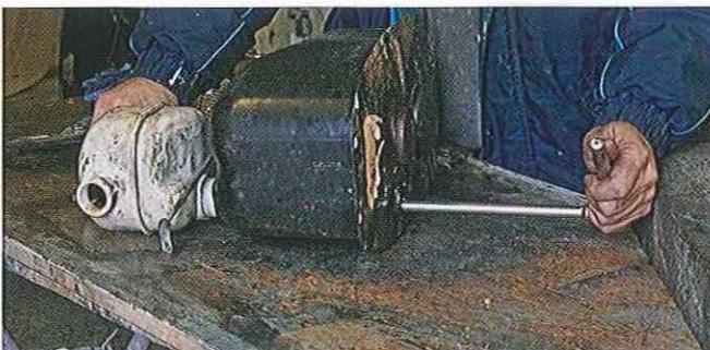
02.9 L'écrou de fixation principale du réservoir d'huile principal est logé au fond du tube de départ d'huile. Il faut une douille de 17 mm avec une extension d'environ 35 cm. Immobilisez l'écrou sur la sortie du réservoir avec une clé plate.
