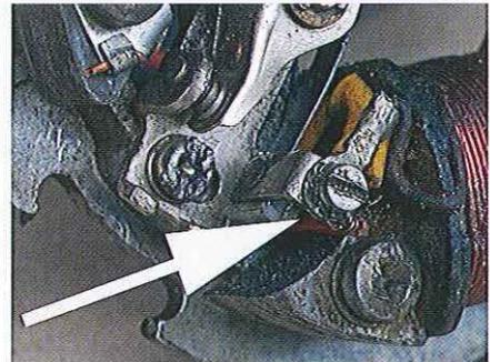
06.22 Le rupteur comporte un connecteur (flèche) vers la bobine haute tension du stator. Notez bien la position de toutes les rondelles isolantes : un ordre incorrect se traduira par un mauvais allumage.
