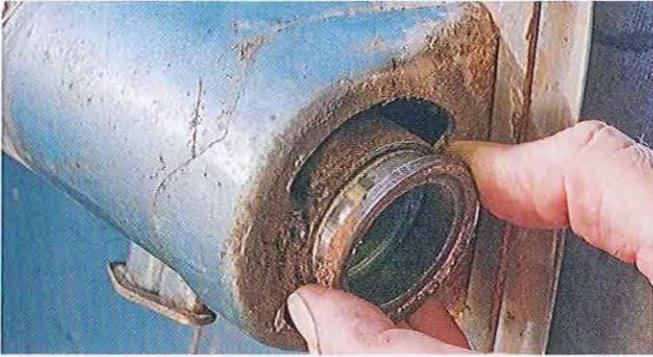
03.250 Deux coups secs doivent débloquer la cuvette dans la coque.
