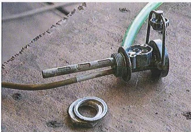
02.19 Le système de filtre des anciens modèles de robinets diffère du dispositif ultérieur. Si le robinet doit être réutilisé, la maille et le tube seront soigneusement inspectés et nettoyés.
