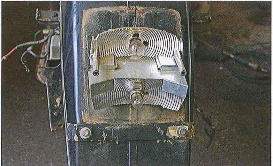
06.9 Contrairement aux modèles antérieurs, le bloc lumineux arrière des PX doit être démonté par le dessous du garde-boue.
