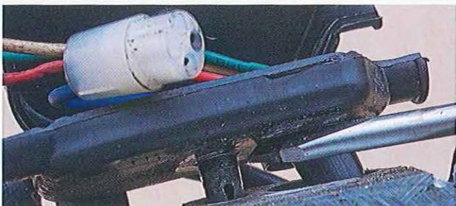
01.48 Le câblage du stator va descendre dans le trou du carter si le boîtier de connexion a été préalablement débranché. On le soulève simplement hors du carter.
