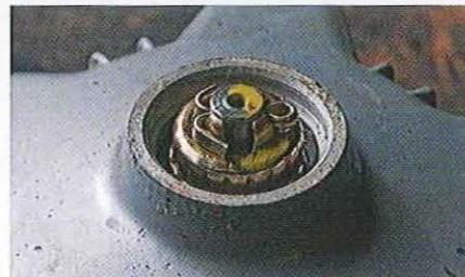
03.174 Disque ou tambour, le moyeu est retenu par un cache arrêté par une goupille sous lequel se trouve l'écrou. Une fois ces pièces démontées, le tambour ou le disque sont libres – au besoin après une légère frappe avec un maillet souple.
