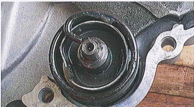
01.101 L'extrémité du ressort peut alors être sortie de son ancrage dans la coupelle en tôle, le ressort retiré et l'arbre extrait du carter de l'extérieur vers l'intérieur.
