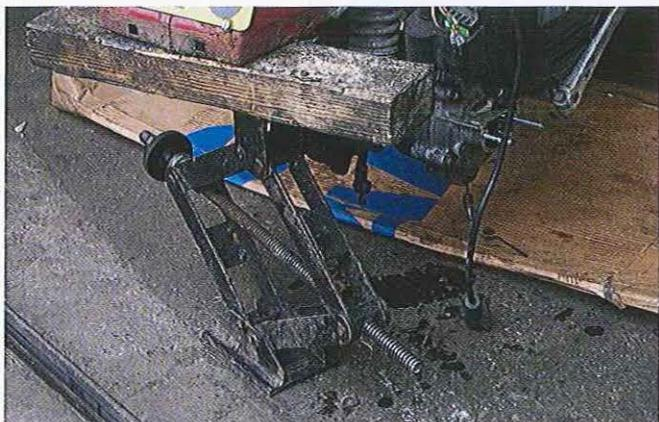
01.11 Pour déposer la roue, supportez l'arrière de la coque – ici sur une cale de bois et un cric à parallélogramme.
