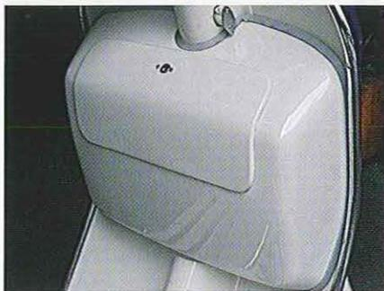
04.77 Les coffres de tablier sont souvent rouillés ou déformés. On trouve des copies, mais un capot d'occasion en bon état peut faire l'affaire. Ils se fixent tous au tablier de la même façon avec des vis prises soit dans le tablier soit sur des pattes soudées. On trouve aussi des capots neufs pour certains modèles.
