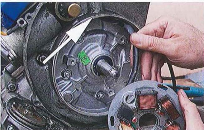
01.49 La platine du stator se sépare facilement du carter et le câblage peut être tiré doucement dans le passage du carter (flèche) et séparé du moteur.
