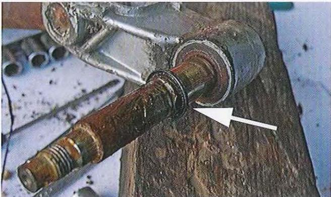
03.178 Une fois le circlip extrait, séparez le porte-moyeu/plateau de frein de la fusée. Il doit y avoir, derrière, des joints à lèvres en caoutchouc (flèche), mais ceux-ci ont pu être détruits ou rester collés au moyeu. Oubliez-les pour le moment.
