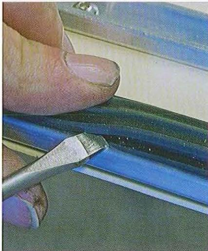
07.21 Le profil des moulures caoutchouc utilisées avant les PX en rend la pose plus problématique car elles ont du mal à prendre leur place. Dans ce cas, glissez un côté dans la baguette en aluminium et poussez l'autre côté en place avec un tournevis. Faire très attention à ne pas dérapier pour ne pas rayer la peinture.
