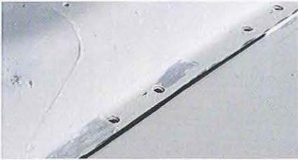
**05.15** Le joint entre le tunnel central et le plancher retient l'eau et la rouille s'installe très vite. Bordez le joint le plus près possible avec du ruban adhésif et forcez un fin cordon de mastic d'étanchéité. N'utilisez pas de mastic-colle à usage domestique qui risque d'accélérer la corrosion.
