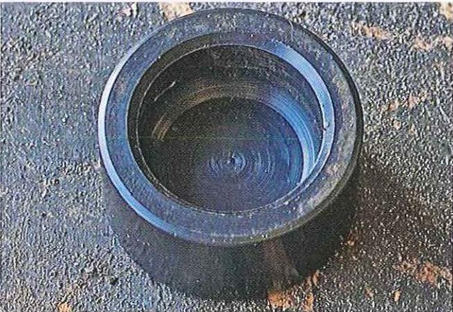
03.236 Les pistons semblent être en assez bon état. Ils ne doivent pas être rayés ou corrodés au point d'endommager les joints.
