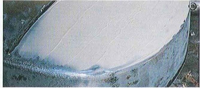
**05.5** Si le panneau est totalement enduit, la nouvelle surface ainsi obtenue facilitera le lissage et le ponçage. Le mastic de finition ne doit pas être épais – une couche mince suffira.
