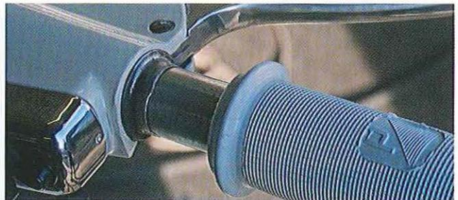
03.33 Les poignées neuves seront lubrifiées avec un peu de savon liquide ou de laque à cheveux puis poussées en place. En cas de blocage prématuré, chauffez-les à l'air chaud et appliquez un mouvement tournant en poussant.
