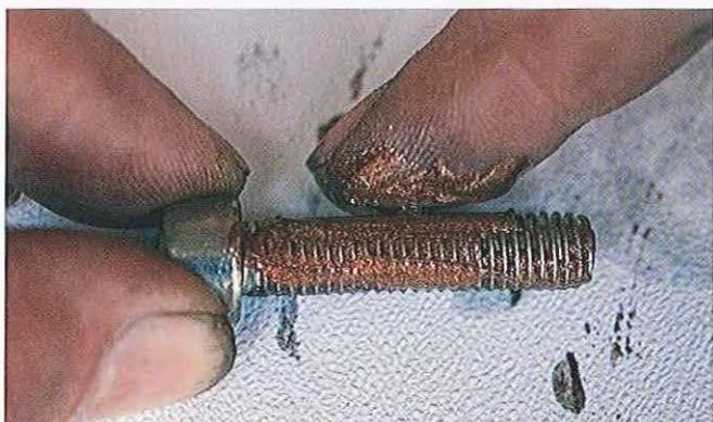
03.240 Enduisez tous les boulons de graisse au cuivre avant remontage.
