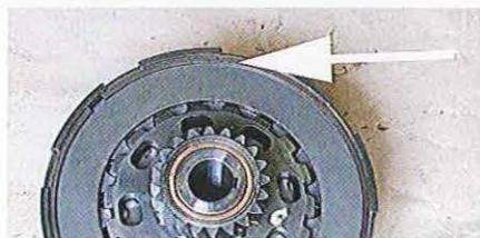
01.221 Comme sur les embrayages antérieurs, les disques sont retenus en place par un jonc (flèche).
