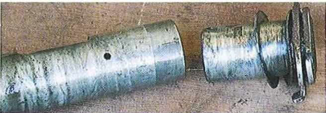
03.13 Un peu de dégrissant et un nettoyage peuvent aider au déboîtage des tubes. Une fois séparés, nettoyez-les à fond et vérifiez qu'ils ne présentent ni rayures ni autres défauts de surface.
