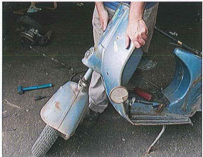
**03.247** Démontez aussi la bague inférieure ; la colonne peut être sortie de la coque. Si le scooter est antérieur aux années 1960, les billes sont libres dans les cuvettes. La plupart des modèles couverts dans cet ouvrage ont des billes encagées bien plus faciles à manipuler.
