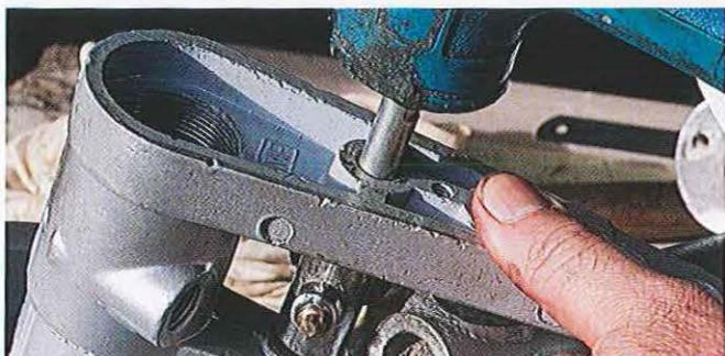
**03.132** Le pivot inférieur du ressort sera monté après lubrification et montage de la plaque de fixation en vérifiant son sens de montage. N'oubliez pas les rondelles d'écartement et vérifiez d'après le dessin éclaté des pièces que l'ordre de montage a été respecté. Après remontage des deux axes, reposez la platine de fixation et serrez les écrous.
