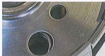
01.217 Sous la pression, les ressorts ne sont pas forcément bien positionnés : mettez-les en place avec un petit tournevis. Un petit claquement signale leur bon alignement.
