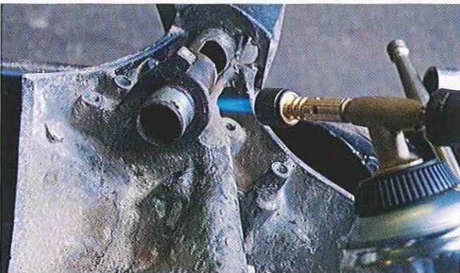
03.51 Ces tubes étaient très corrodés comme le tunnel qu'ils traversaient. On a chauffé légèrement l'alliage pour réduire le serrage tout en appliquant du dégrissant.
