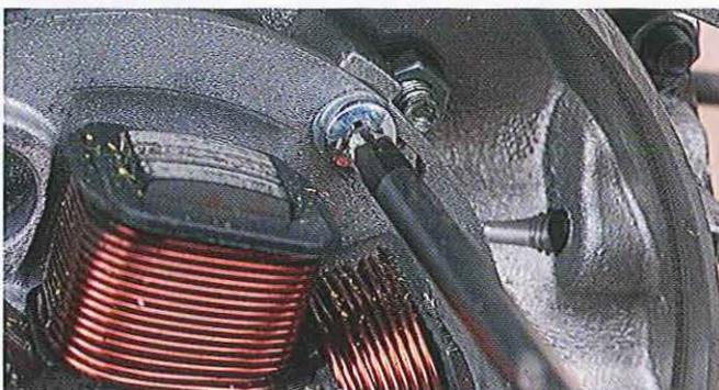
01.47 Les vis sont très serrées (ou doivent l'être). La lame du tournevis doit correspondre exactement à l'empreinte de la tête pour avoir une meilleure prise et pour éviter de l'abîmer.
