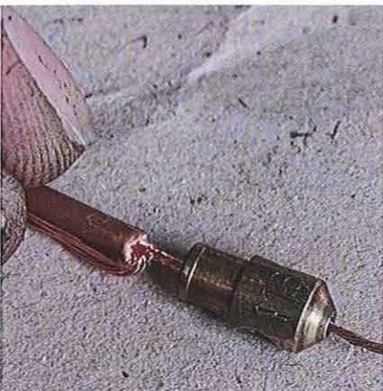
**02.27** Les gicleurs ne demandent qu'un nettoyage par air comprimé. Si des dépôts subsistent, utilisez un petit morceau de fil de cuivre pour les éliminer. Mais les gicleurs neufs ne sont pas coûteux.
