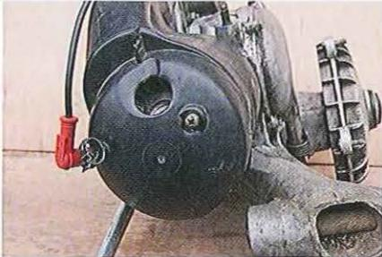
01.21 Le carénage de refroidissement de la culasse – en tôle sur les premiers moteurs, en plastique par la suite – est tenu par une vis en haut...
