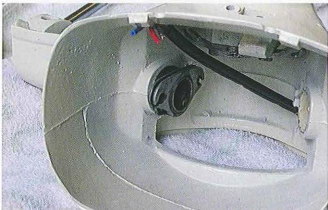
03.21 Graissez les poulies d'enroulement des câbles au niveau de la partie encastrée dans l'aluminium pour prévenir la corrosion.
