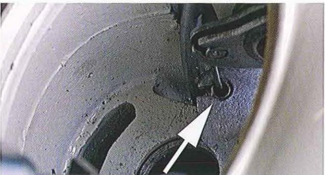
03.25 Ces câbles sont pourvus d'embouts en métal (flèche) déjà sertis sur les gaines. S'ils manquent, remontez les embouts dès maintenant. Vérifiez que les câbles sont correctement orientés vers les gaines et qu'ils ne risquent pas de frotter quand ils seront actionnés.
