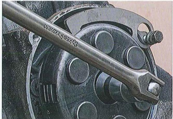
01.60 Après immobilisation du mécanisme, desserrez l'écrou central.
