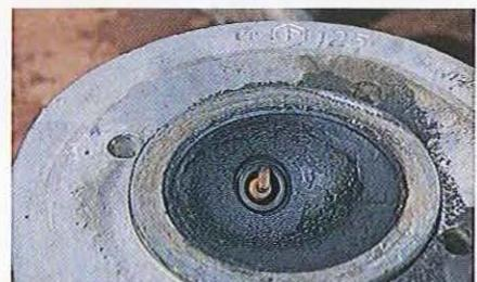
01.26 La culasse libérée peut alors être inspectée. Examinez la portée circulaire qui s'appuie sur le cylindre pour y détecter d'éventuelles fuites de gaz, révélées par une marque ou des piqûres de l'aluminium. Les dépôts de calamine dans la chambre de combustion sont normaux.
