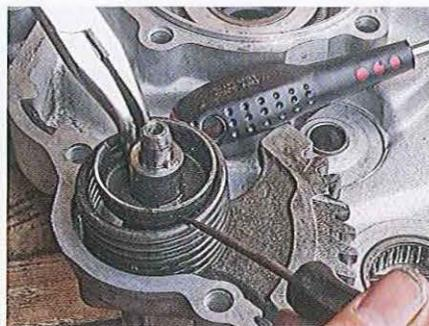
01.190 Insérez l'axe du kick dans son logement et la partie rectiligne du ressort dans le trou d'ancrage du carter.
