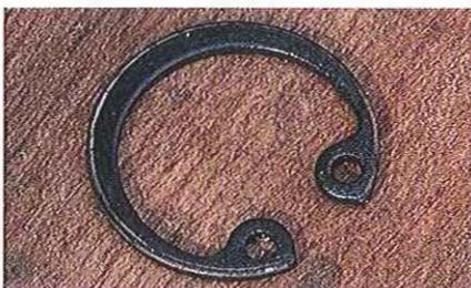
01.33 Le piston est articulé sur la bielle par un axe retenu à chaque extrémité par un anneau élastique ("circlip") comme celui-ci.
