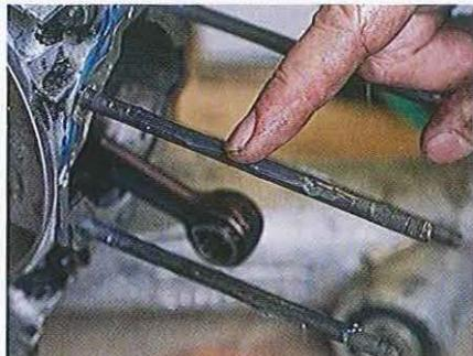
01.263 Graissez les tiges des goujons pour éviter la corrosion.
