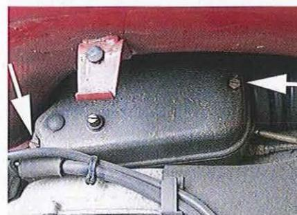
01.2 Le couvercle du boîtier du carburateur est fixé par deux vis (flèches). Dévissez et retirez le couvercle. Le filtre à air s'enlève ensuite après desserrage de deux vis de chaque côté de la grande vis de réglage du ralenti.
