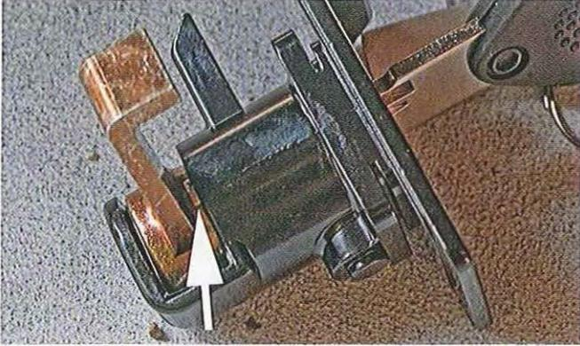
07.65 Le barillet de la clé de verrouillage est retenu par un ergot à ressort. Appuyez sur l'ergot et tirer le barillet hors de la serrure à l'aide de la clé.
