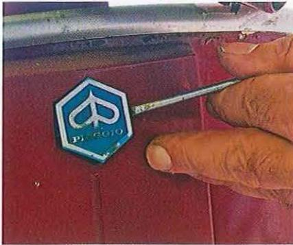
07.3 Les écussons en plastique de la série P vieillissent comme les modèles antérieurs. On peut les retirer en glissant avec précaution une lame de tournevis sous l'écusson pour repousser les languettes de retenue.
