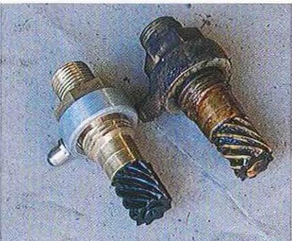
03.154 Entraînements de compteur ancien et neuf. Apparemment identiques, le neuf fourni dans le kit ne se montait pas sur le moyeu.
