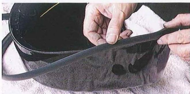
07.61 Les garnitures caoutchouc des capots latéraux se glissent simplement en place sur tous les modèles. Les pièces qui ne sont pas d'origine devront être découpées autour des fixations avant (selon modèle).
