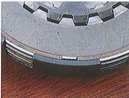
01.233 Reposez le jonc de retenue en vérifiant que ses extrémités sont bien positionnées dans la cloche pour une sécurité maximale.
