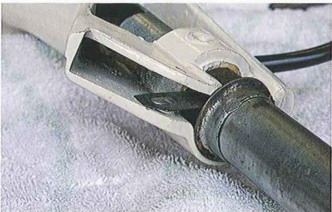
03.23 N'oubliez pas de reposer la bague de friction côté poignée de gaz retenue par le boulon pivot du levier.
