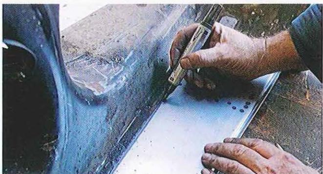
04.19 Positionnez le nouveau plancher. Une fois aligné (et l'ancien plancher coupé à l'avant si vous avez choisi initialement de couper du bon côté), marquez la position du tunnel et des trous de la béquille de façon à le poser à la bonne place après avoir été percé pour les soudures en bouchon qui serviront à le tenir.
