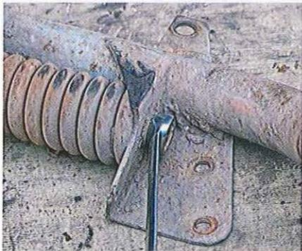
**03.100** Retirez l'écrou du chapeau supérieur du ressort et séparez le chapeau de la platine de fixation supérieure. L'ensemble doit être libéré.
