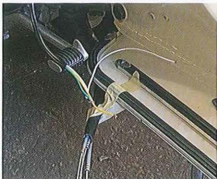
01.297 Attachez les fils et les câbles pour dégager l'emplacement du moteur.
