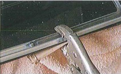
07.20 Si un écart important sépare encore les moulures et la tôle du plancher et si vous comptez sur les fixations pour obtenir la bonne courbure comme on l'a dit précédemment, les rivets ne seront pas la bonne solution car l'aluminium pourrait se déchirer. Pour éviter ce problème, serrez la baguette sans excès sur la tôle avec des protections, puis posez le rivet. Les fixations vissées ne demandent pas ce blocage supplémentaire car elles serrent plus progressivement que les rivets «pop».
