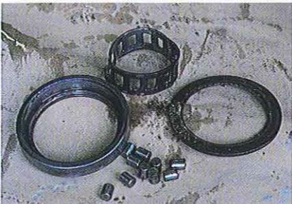
01.117 Les pièces du roulement ne sont pas faciles à sortir avec leurs rebords très étroits difficilement accessibles. Elles sont aussi montées assez serrées. Une fois extraites, leur assemblage est évident.
