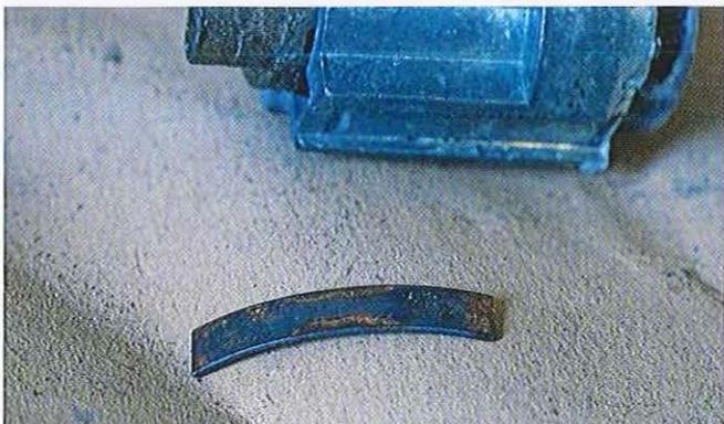
04.101 Le barillet principal est retenu par une lamelle de métal élastique qui se loge dans une gorge sur le côté du barillet lui-même.
