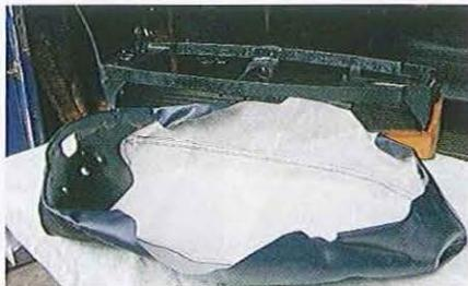
07.39 Le revêtement de selle neuf peut être livré avec des pièces de renfort déjà fixées à l'avant et à l'arrière, sinon réutilisez les morceaux d'origine. Le revêtement est plus facile à poser par temps chaud car il sera plus souple. S'il fait froid, réchauffez le tissu pour l'assouplir avec de l'air chaud ou brièvement au sèche-linge.
