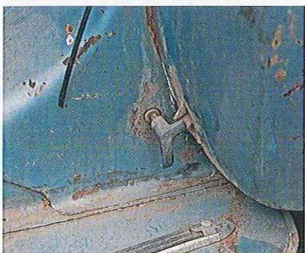
**04.67** Les capots latéraux des modèles pré-PX EFL sont retenus par ces loquets qu'il faut tirer et tourner pour les dégager des gâches des capots.
