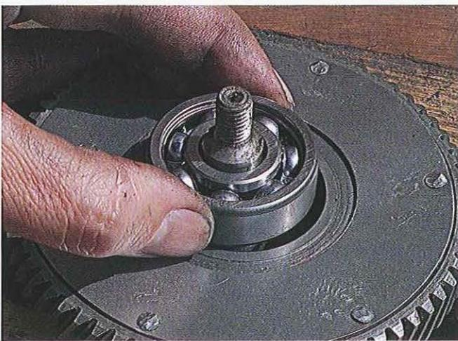
01.163 Remontez l'arbre puis le roulement en le chassant en place avec une douille portant sur la bague intérieure.
