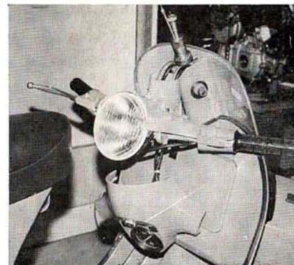
Les câbles sont suffisamment longs pour laisser pendre le phare et son capotage. (Photo RMT).
