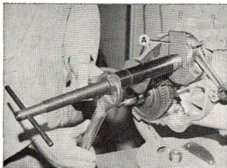
Repose de la bague intérieure du roulement à aiguilles de vilebrequin, avec l'outil T. 0018119. Ne pas oublier l'entretoise A. (Photo RMT).
