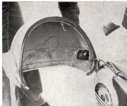
Pour déposer un capot, dégager d'abord la partie avant. (Photo RMT).
