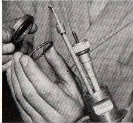
Repose du roulement supérieur de colonne de direction. (Photo RMT).
