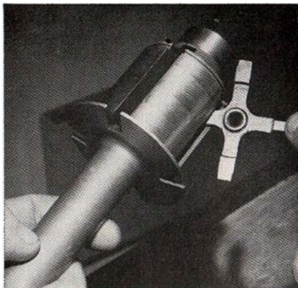
A la repose du croisillon, respecter son sens de montage, l'épaulement autour de son alésage fileté doit être côté roue arrière. (Photo RMT).
