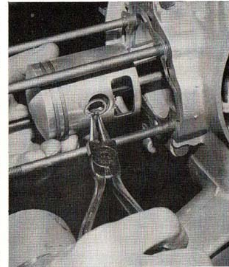
Extraction des circlips d'axe de piston. (Photo RMT).
