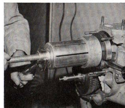
Extraction de la bague intérieure du roulement à aiguilles à l'aide de l'outil T. 0014449. (Photo RMT).
