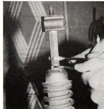
Sur l'amortisseur arrière, dépose de l'écrou avec le silentbloc. (Photo RMT).
