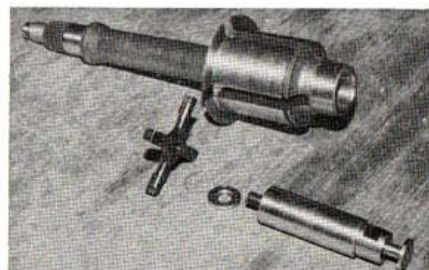
Le croisillon, vissé sur son axe, se déplace dans les fentes du manchon de l'arbre secondaire. (Photo RMT).
