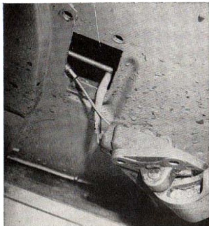
L'accès au câble de frein arrière nécessite la dépose de sa pédale. (Photo RMT).
