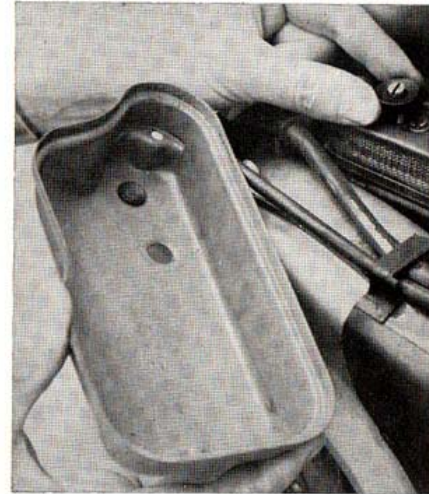
Avant de reposer le couvercle du boîtier de filtre, s'assurer de la présence de l'entretoise en caoutchouc qui se glisse autour de la vis de régime de ralenti. (Photo RMT).
