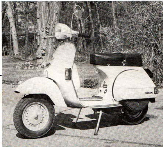
Les clignotants s'intègrent parfaitement dans la ligne générale, ainsi que la roue de secours, dissimulée par un cache. (Photo RMT).
