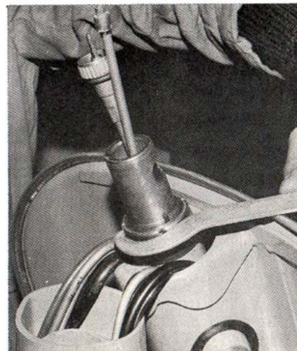
Réglage du jeu à la colonne de direction (Photo RMT).
